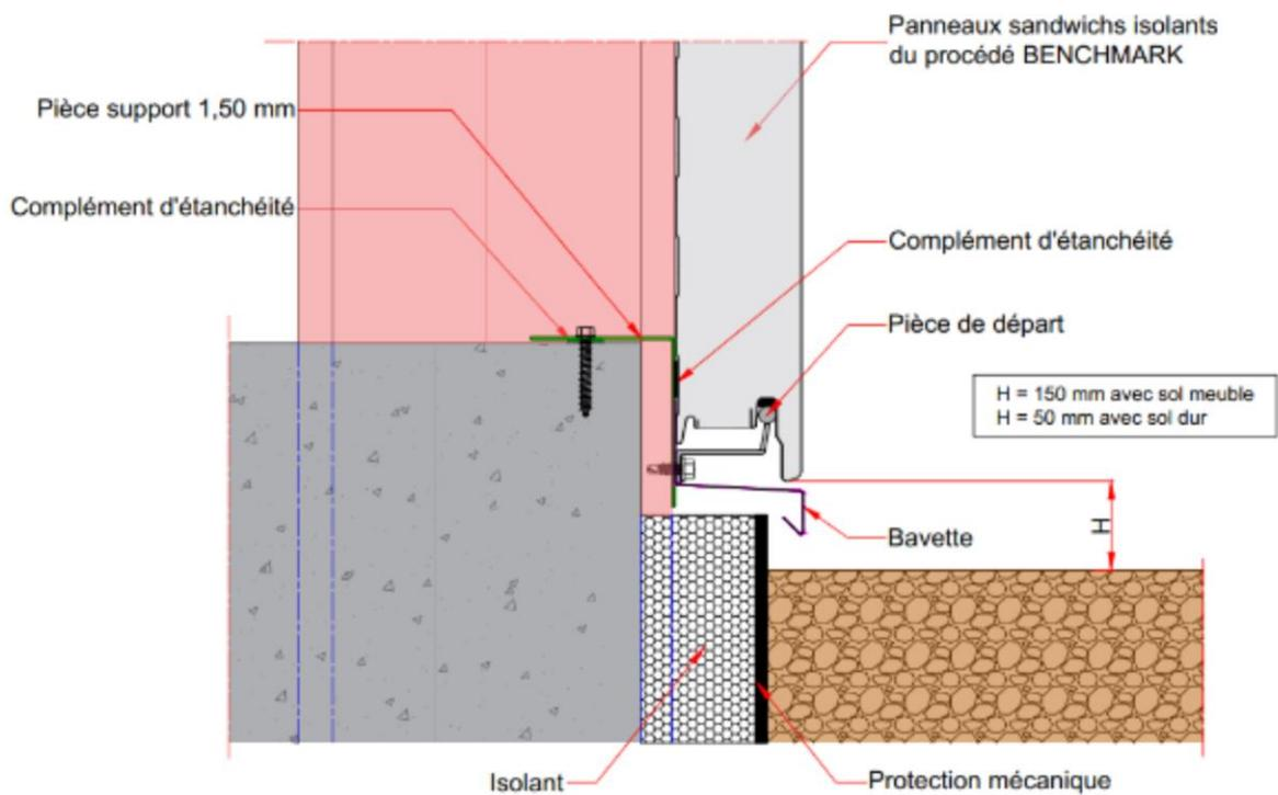
**Figure 15 – Bas de bardage en pose horizontale devant longrine**
