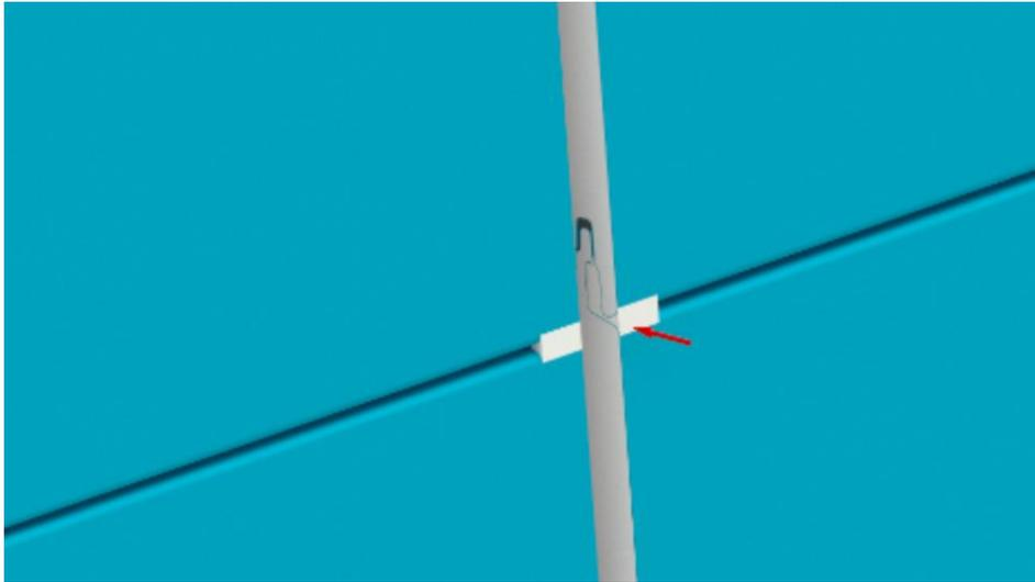
**Obturation de l'emboîtement en face extérieure par garnissage de mastic silicone**
