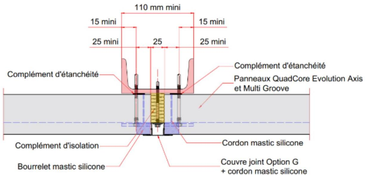
**Figure 23 – Exemple d'une jonction verticale en pose horizontale avec panneaux sandwich isolants Evolution Axis ou Multi Groove et couvre-joint option G (Affleurant) sur ossature acier**
