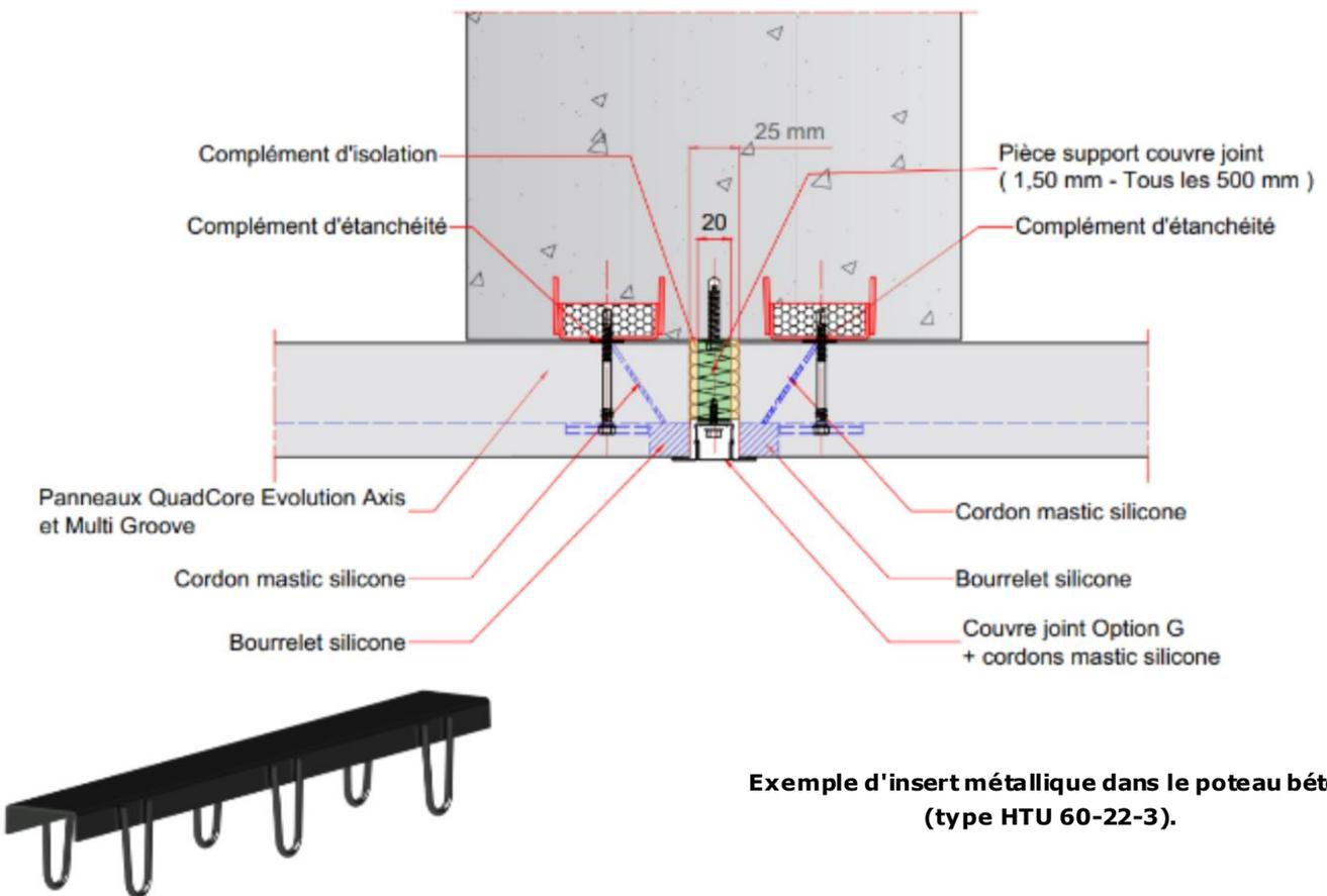
**Figure 21 – Exemple d'une jonction verticale en pose horizontale avec panneaux sandwich isolants Evolution Axis ou Multi Groove et couvre-joint option G (Affleurant) sur ossature béton**
