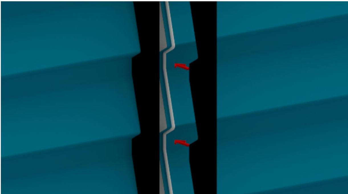
**Pose du contre cloisir avant mise en place des façonnés et/ou des couvre-joints**
