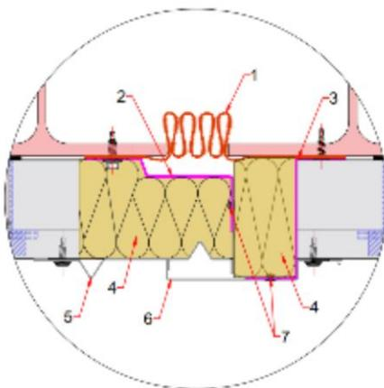
(1) : Membrane mise en place entre l'ossature et les pièces (2) et (3).
