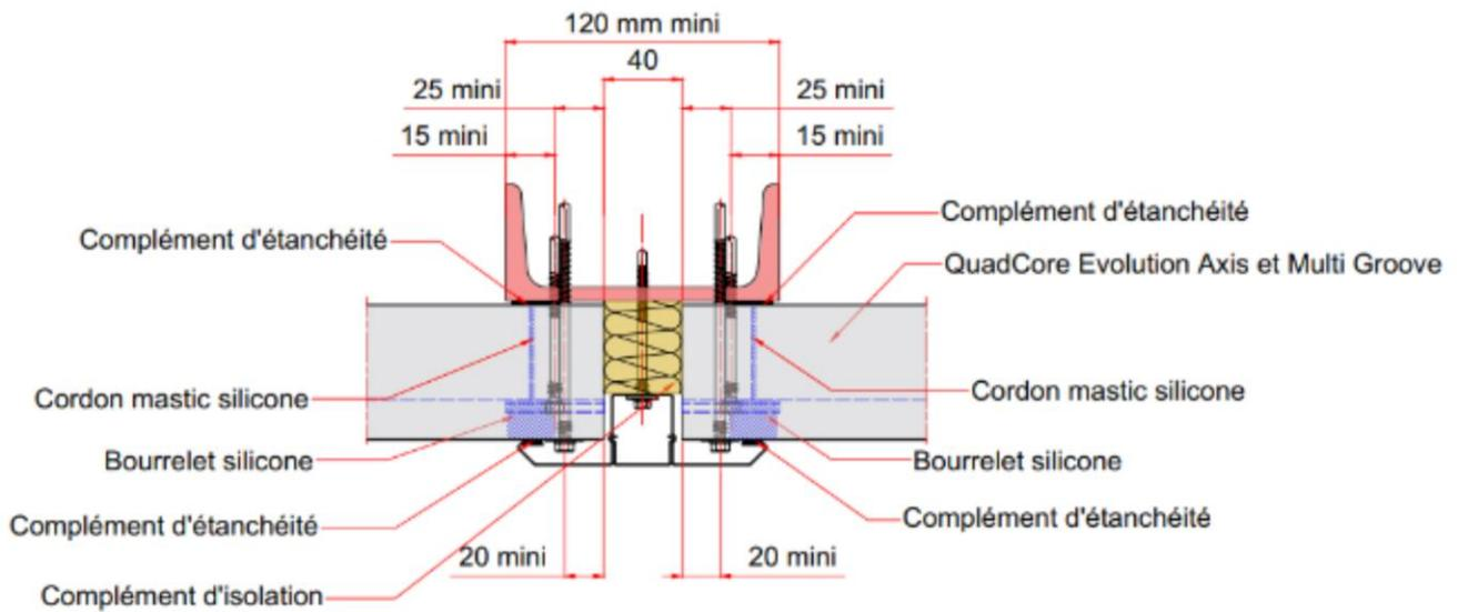
**Figure 28 – Exemple d'une jonction verticale en pose horizontale avec panneaux sandwich isolants BENCHMARK et 2 fixations traversantes complémentaires par largeur de panneau – Conception 1 avec panneaux Evolution Axis représenté**
