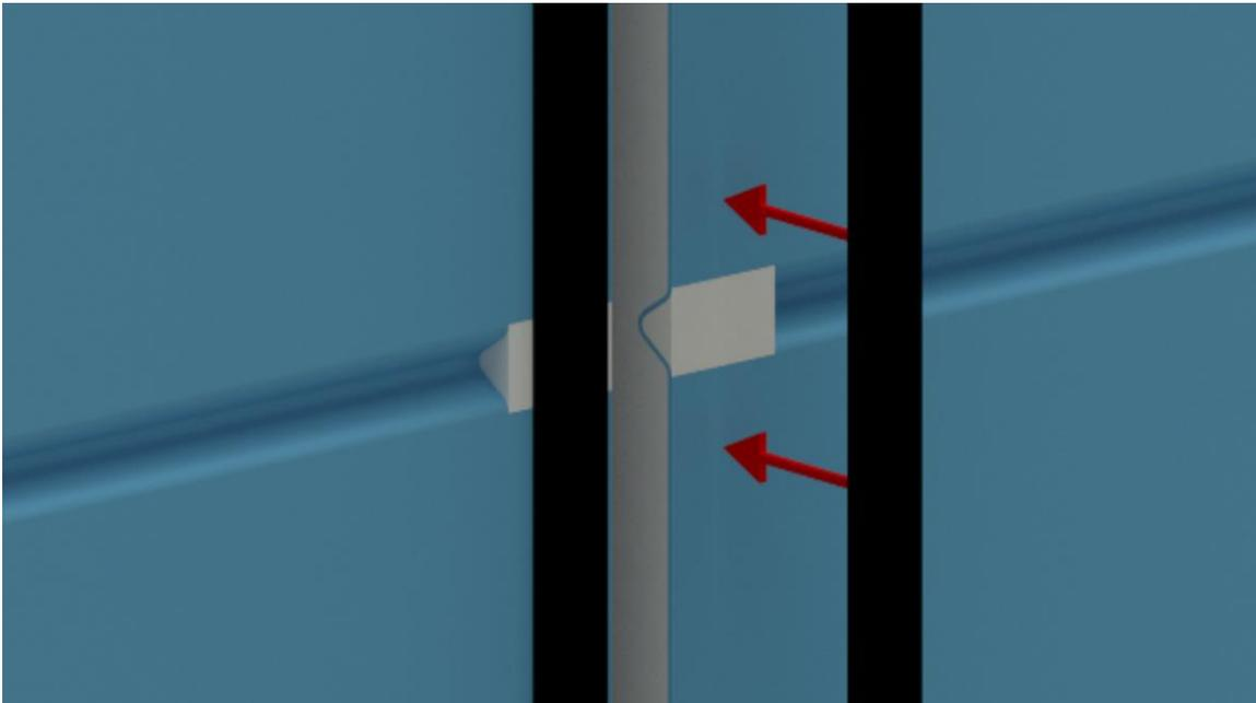
**Pose des compléments d'étanchéité verticaux avant mise en place des façonnés et/ou des couvre-joints**
