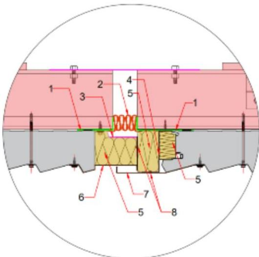
(1) : Tôle filante d'épaisseur minimale 0,60 mm en forme de L fixée sur chaque lisse.
