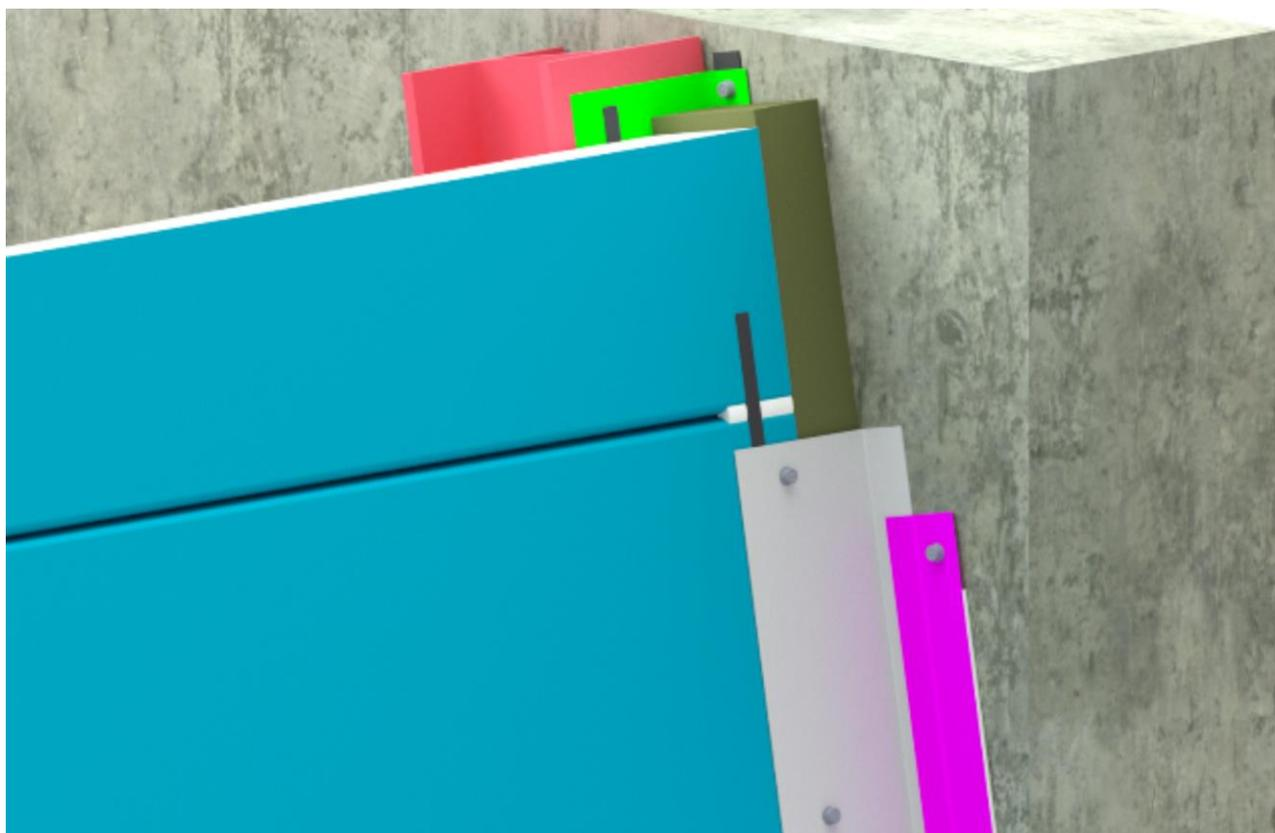
**Figure 12 ter – Dispositions complémentaires sur façade inclinée à fruit positif maximal 10° (inclinaison vers l'intérieur) – Rive contre mur**
