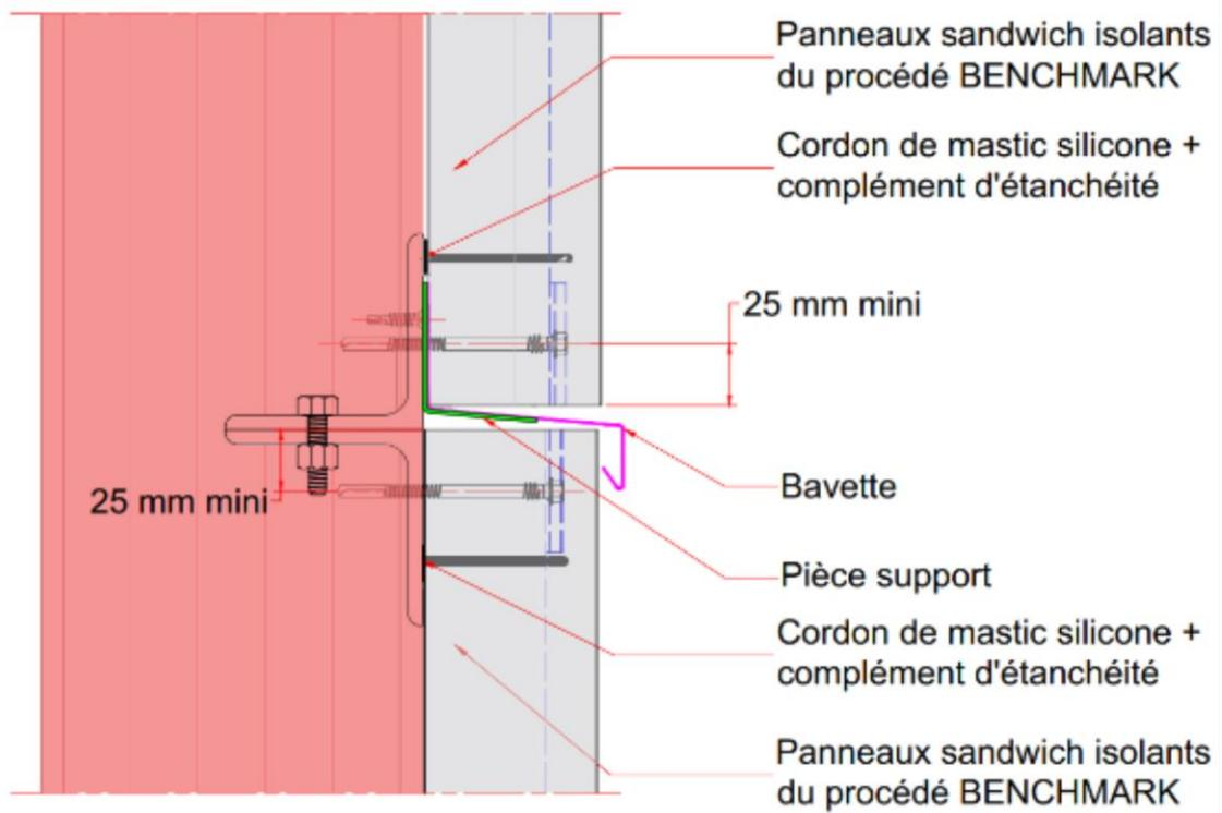
**Figure 18 – Jonction horizontale en pose verticale**
