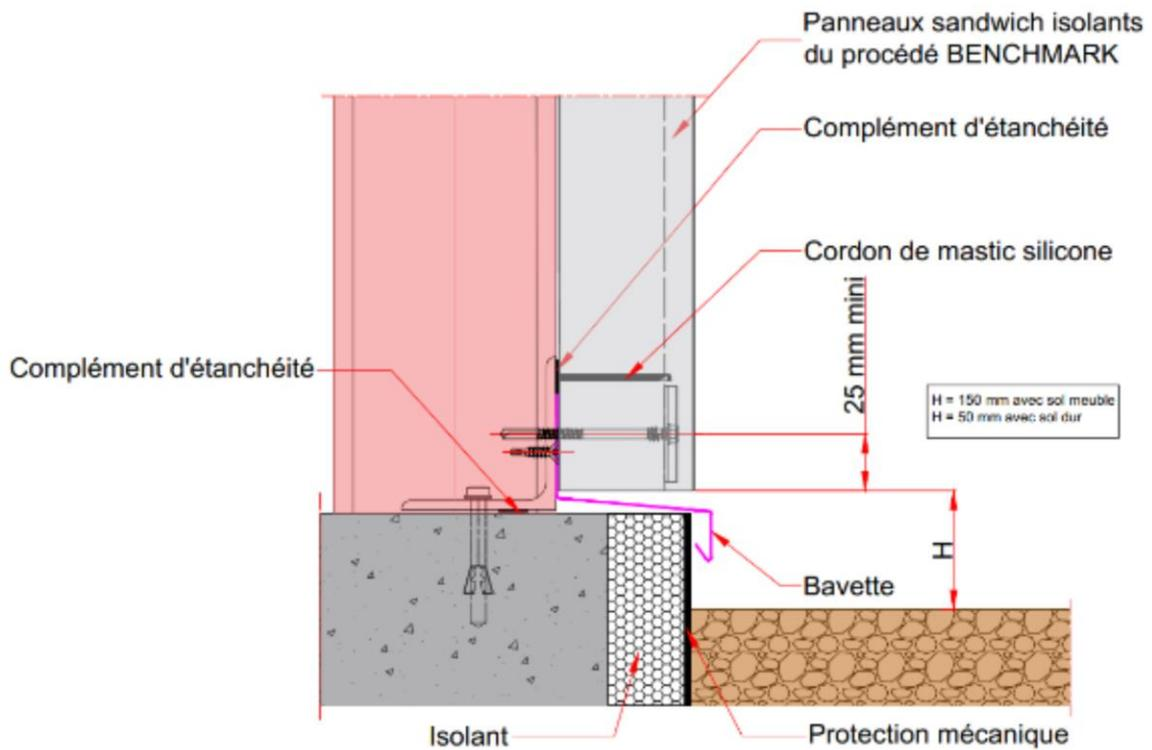
**Figure 14 bis – Bas de bardage en pose verticale sur longrine**
