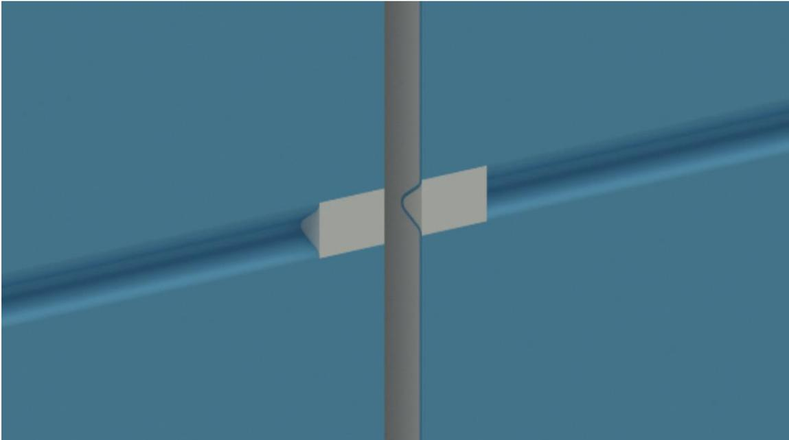
**Garnissage des V du parement extérieur par un bourrelet de mastic silicone**
