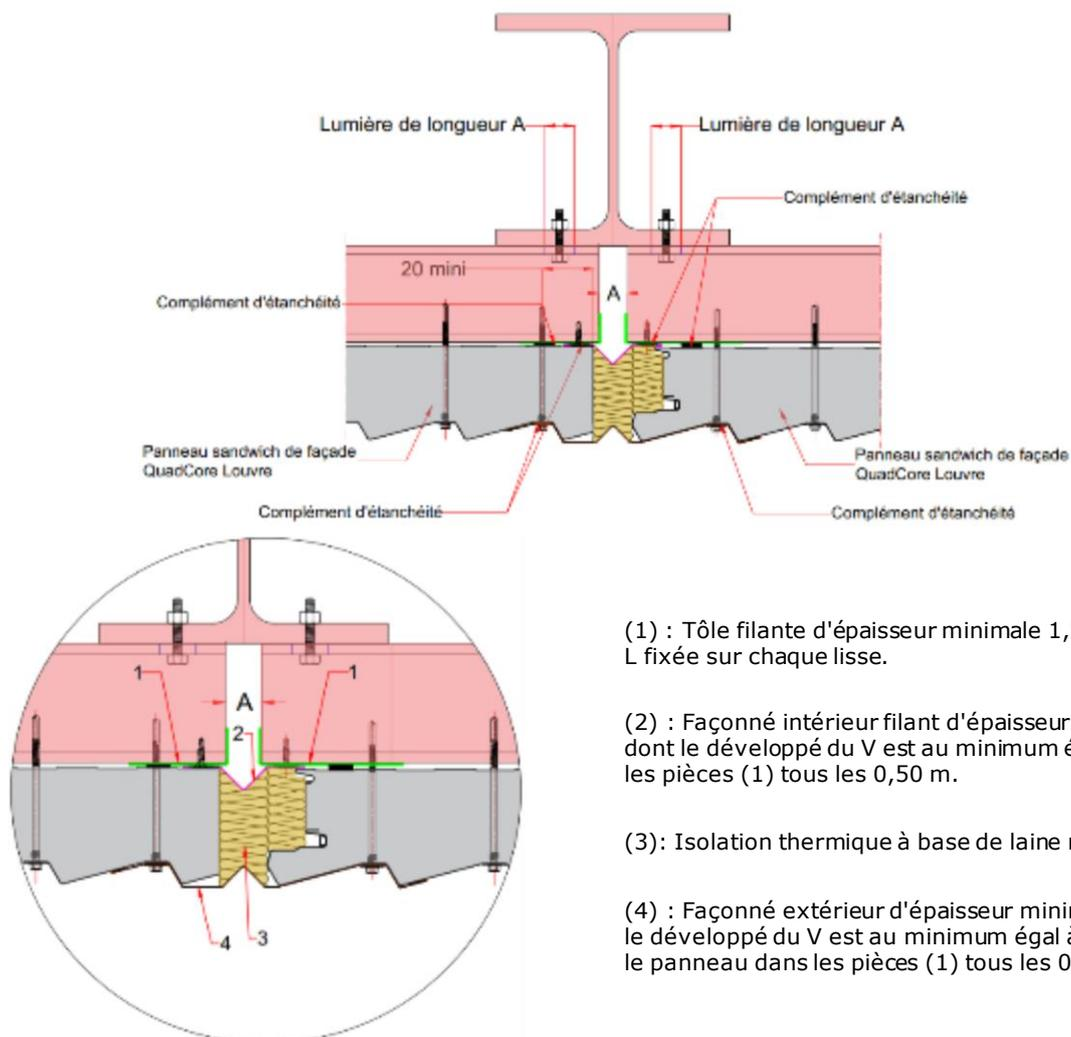
(1) : Tôle filante d'épaisseur minimale 1,50 mm en forme de L fixée sur chaque lisse.
