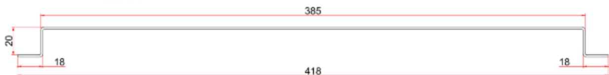
**Figure 51 bis – Exemple d'un joint de dilatation dont le déplacement maximal est de 50 mm avec panneau sandwich isolant Louvre en pose horizontale**
