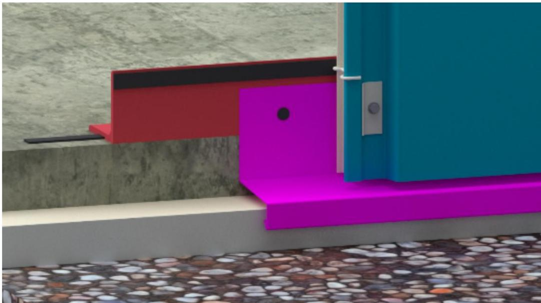
**Pose avant emboîtement d'un cordon de mastic silicone à relier au complément d'étanchéité sur appui**
