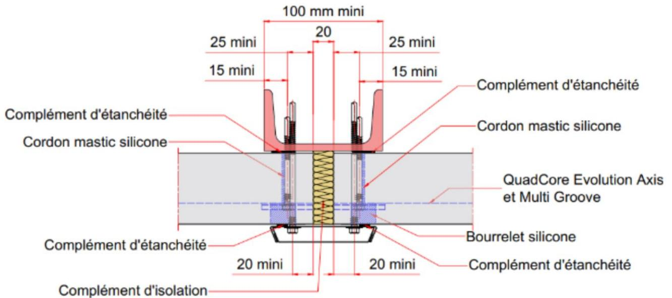
**Figure 29 – Exemple d'une jonction verticale en pose horizontale avec panneaux sandwich isolants Evolution Axis ou Multi Groove et 2 fixations traversantes complémentaires par largeur de panneau – Conception 2**
