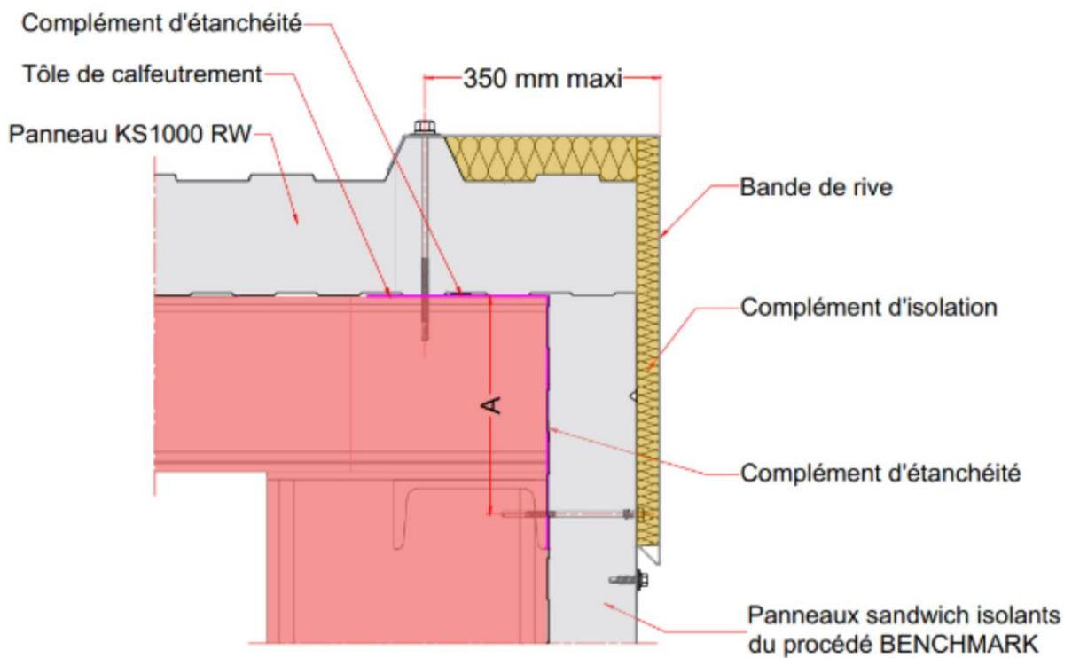
**A : Porte à faux est limité à 1/3 de la largeur utile du panneau sandwich isolant avant sa découpe sans être inférieur à 20 mm**
