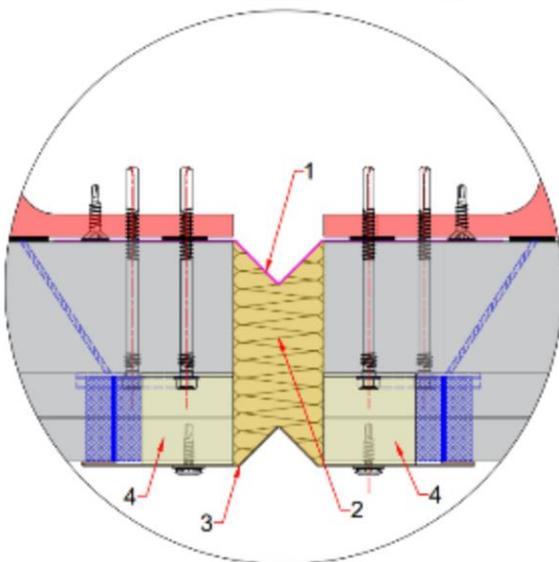
(1) : Façonné intérieur filant d'épaisseur minimale 0,60 mm dont le développé du V est au minimum égal à A et fixé dans l'ossature tous les 0,50 m.
