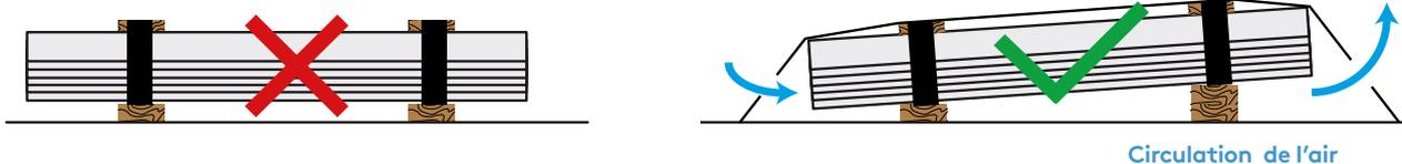
Afin d'éviter une altération superficielle des revêtements il est recommandé que les paquets ne soient pas recouverts uniquement d'une feuille de plastique et entreposé à l'extérieur. De plus en cas de contact avec la pluie ou la condensation, les éléments profilés galvanisés ou galvanisés pré laqués doivent être immédiatement redressés et séchés séparément pour éviter toute oxydation de leur surface.
