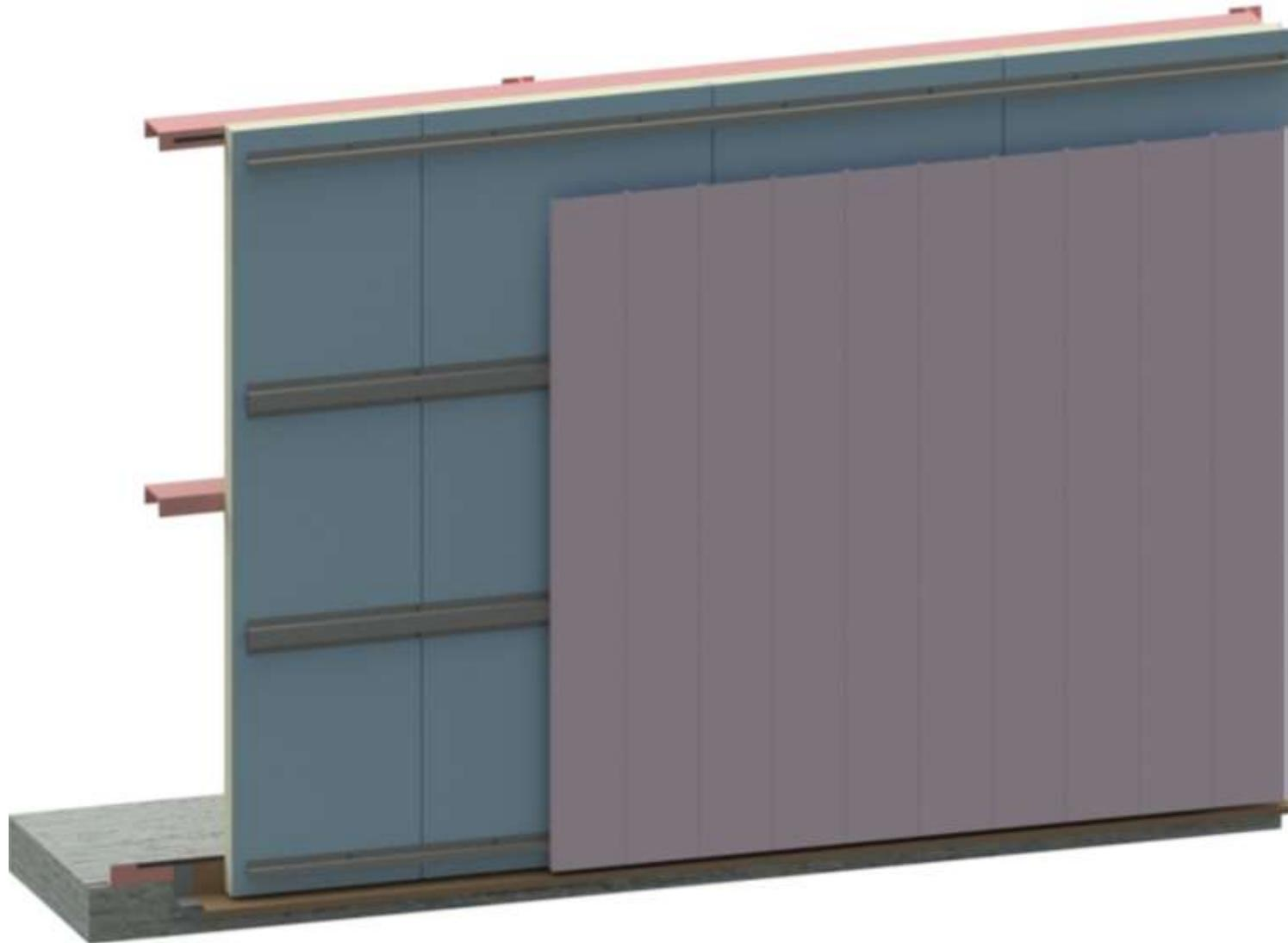
**Figure 12 : Exemple d'un parement extérieur de la typologie 2 en pose directe sur les profilés fixés sur les panneaux sandwich isolants posés verticalement**
