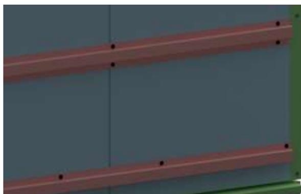
**Détail D** : Fixation des l'extrémité des profilés en forme d'oméga et de zed à travers le panneau sandwich isolant dans le poteau de charpente.
