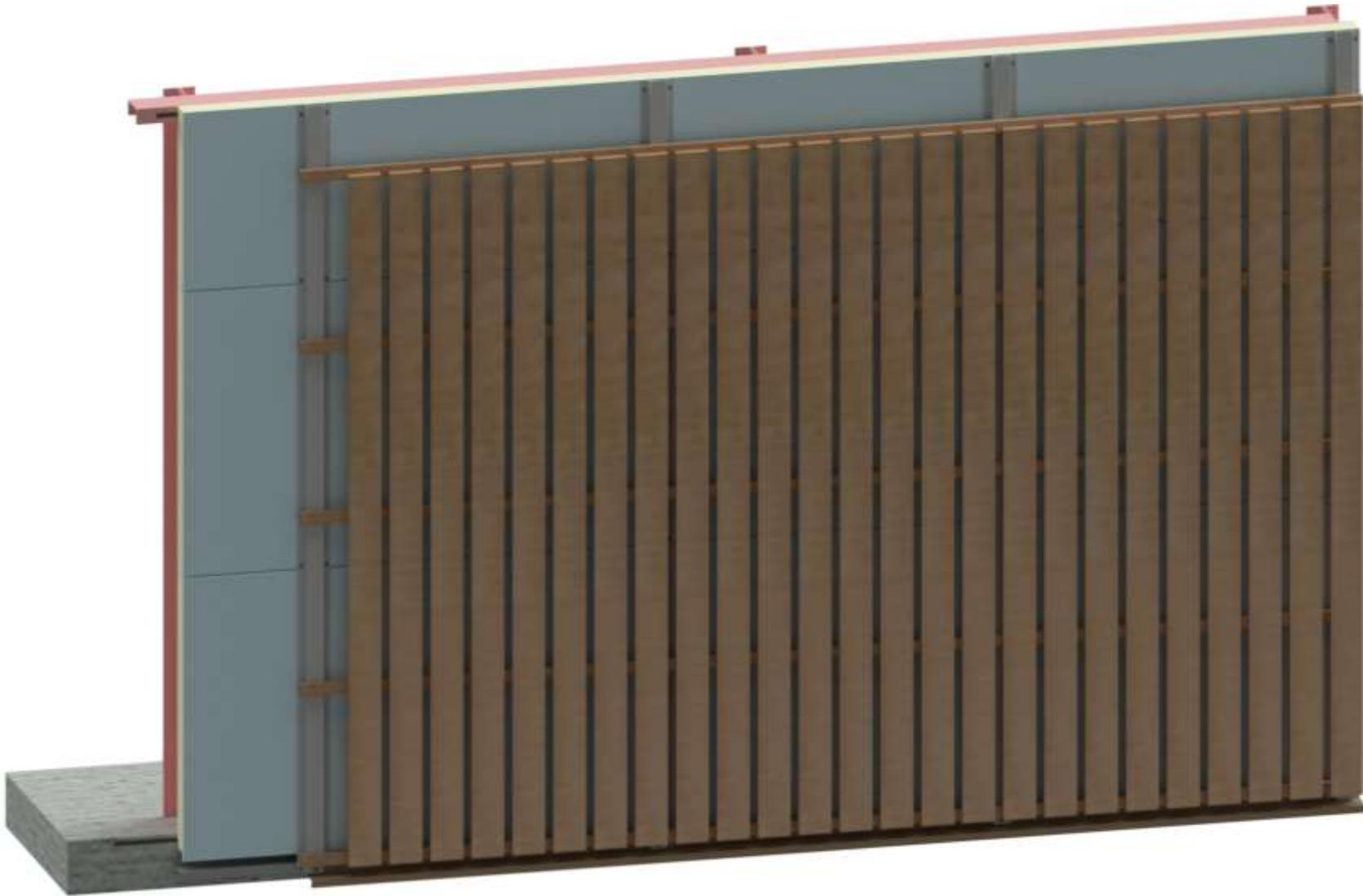
**Figure 8 : Exemple d'un parement extérieur de la typologie 4 avec pose sur chevrons en tant que double réseau avec panneaux sandwich isolants posés horizontalement.**
