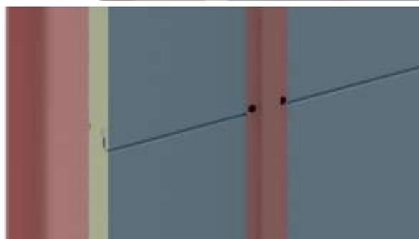
**Détail C** : Fixation des profilés en forme d'oméga au niveau de chaque emboîtement des panneaux sandwich isolants par 2 vis (cf. figure 22).
