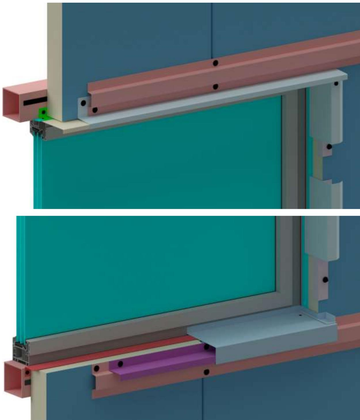
**Figure 38 bis : Exemple de baie avec parement extérieur de la typologie 1 sur simple réseau avec panneaux sandwich isolants posés verticalement – Vues 3D détails**
