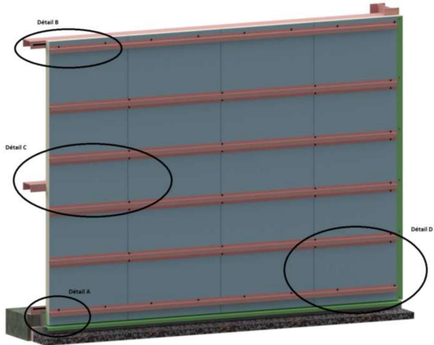
Figure 10 : Schéma de principe avec profilés fixés sur les panneaux sandwich isolants posés verticalement - Parements extérieurs des typologies 1 à 7
