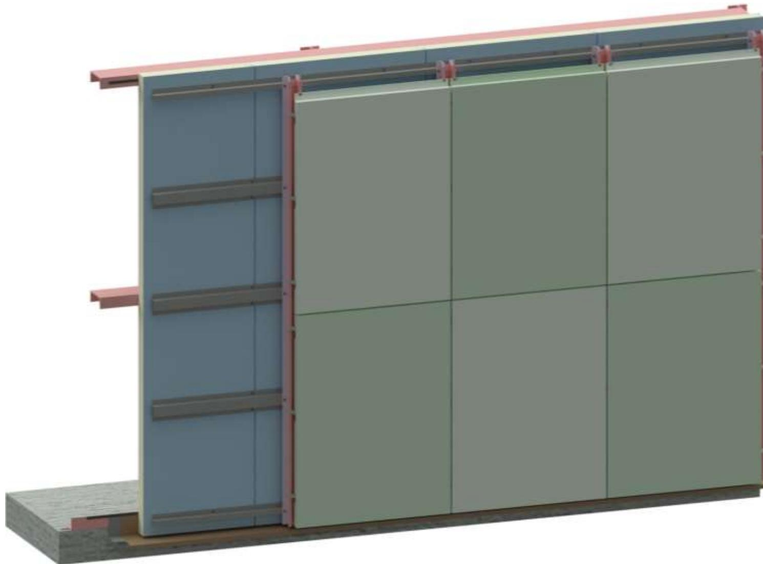
**Figure 15 : Exemple d'un parement extérieur de la typologie 5 avec profilé spécifique d'accrochage en double réseau de profilés avec panneaux sandwich isolants posés verticalement**
