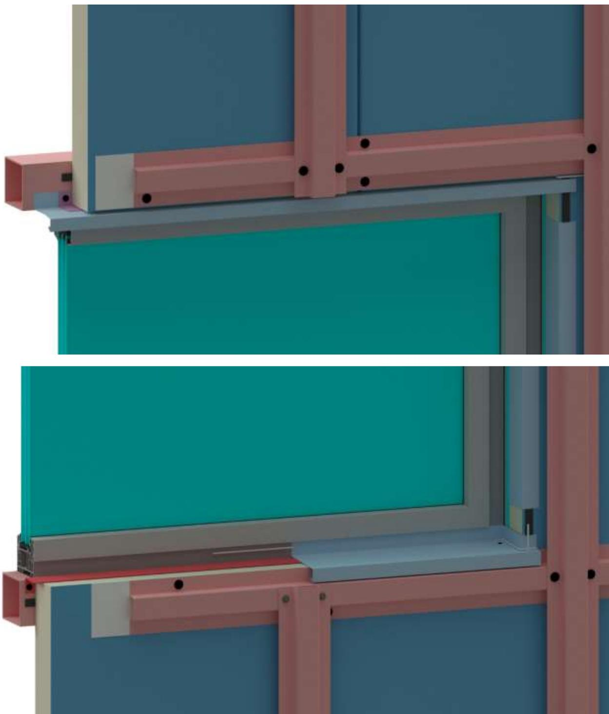
**Figure 39 bis : Exemple de baie avec parement extérieur de la typologie 4 à « claire-voie » sur double réseau avec panneaux sandwich isolants posés verticalement – Vues 3D détails**
