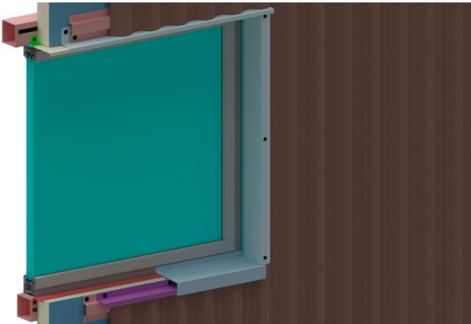
**Figure 38 : Exemple de baie avec parement extérieur de la typologie 1 sur simple réseau avec panneaux sandwich isolants posés verticalement – Vue 3D générale**
