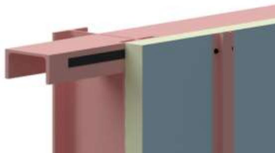
**Détail B** : Fixation de l'extrémité haute des profilés en forme d'oméga à travers le panneau dans la lisse haute de charpente par 2 vis.
