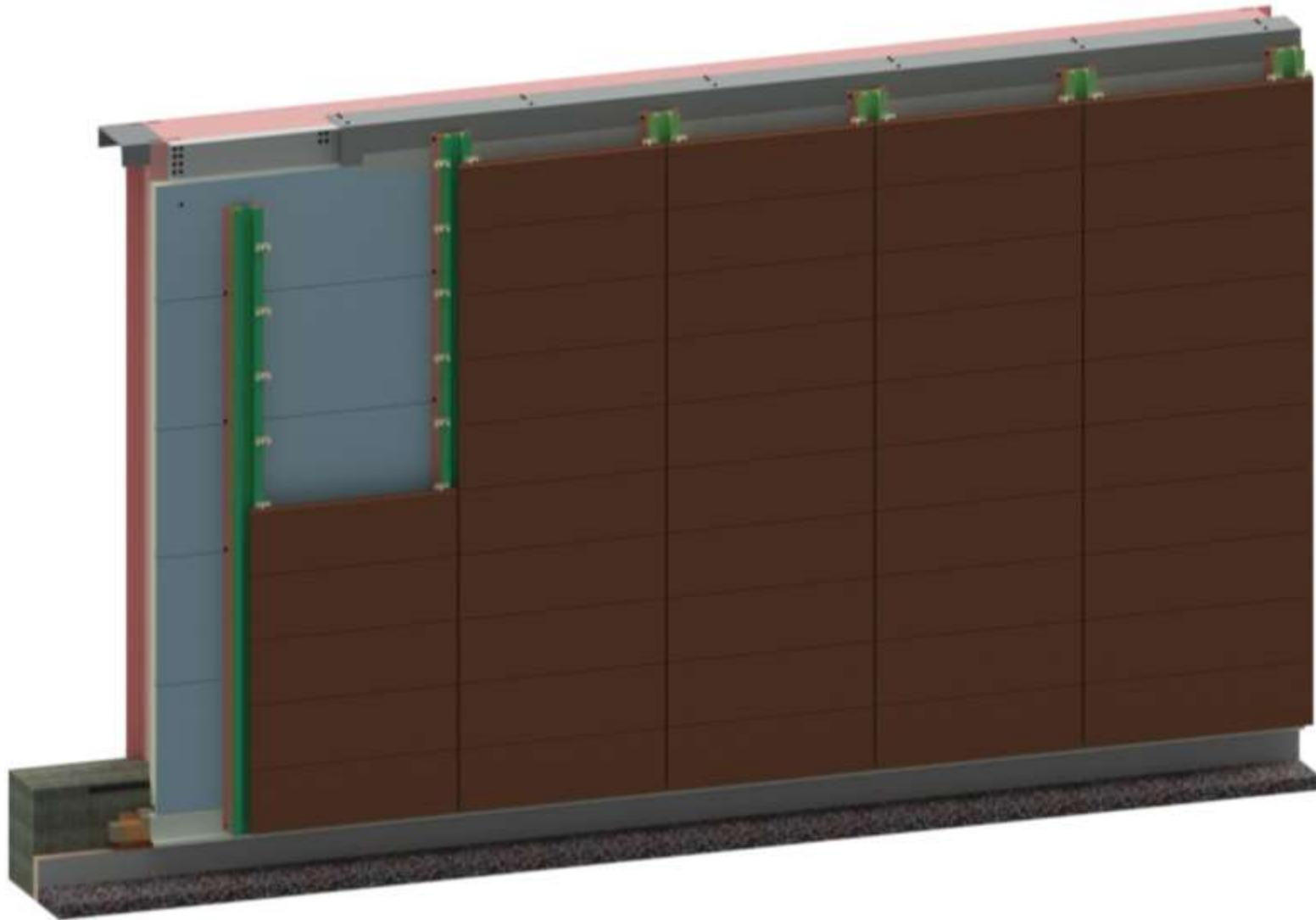
Figure 20 : Exemple d'un parement extérieur de la typologie 8 sur profilés en superposition avec panneaux sandwich isolants posés horizontalement
