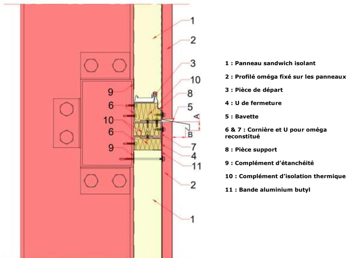
**A** : Recouvrement mini de 30 mm sur le parement extérieur
