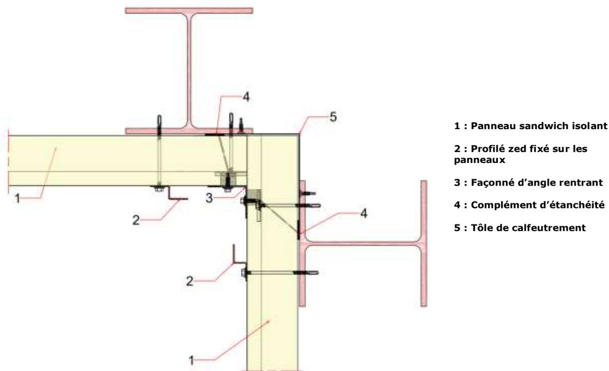
**Figure 34 : Schéma de principe d'un angle rentrant avec simple réseau et panneaux sandwich isolants posés horizontalement**
