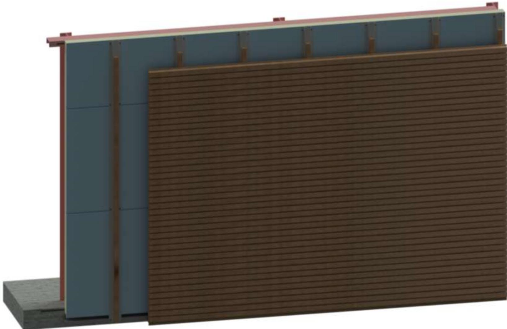
**Figure 5 : Exemple d'un parement extérieur de la typologie 4 avec pose en superposition de chevrons sur les profilés fixés sur les panneaux sandwich isolants posés horizontalement.**
