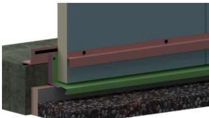
**Détail A** : Fixation des profilés en forme zed à travers le panneau sandwich isolant dans la lisse basse de charpente.
