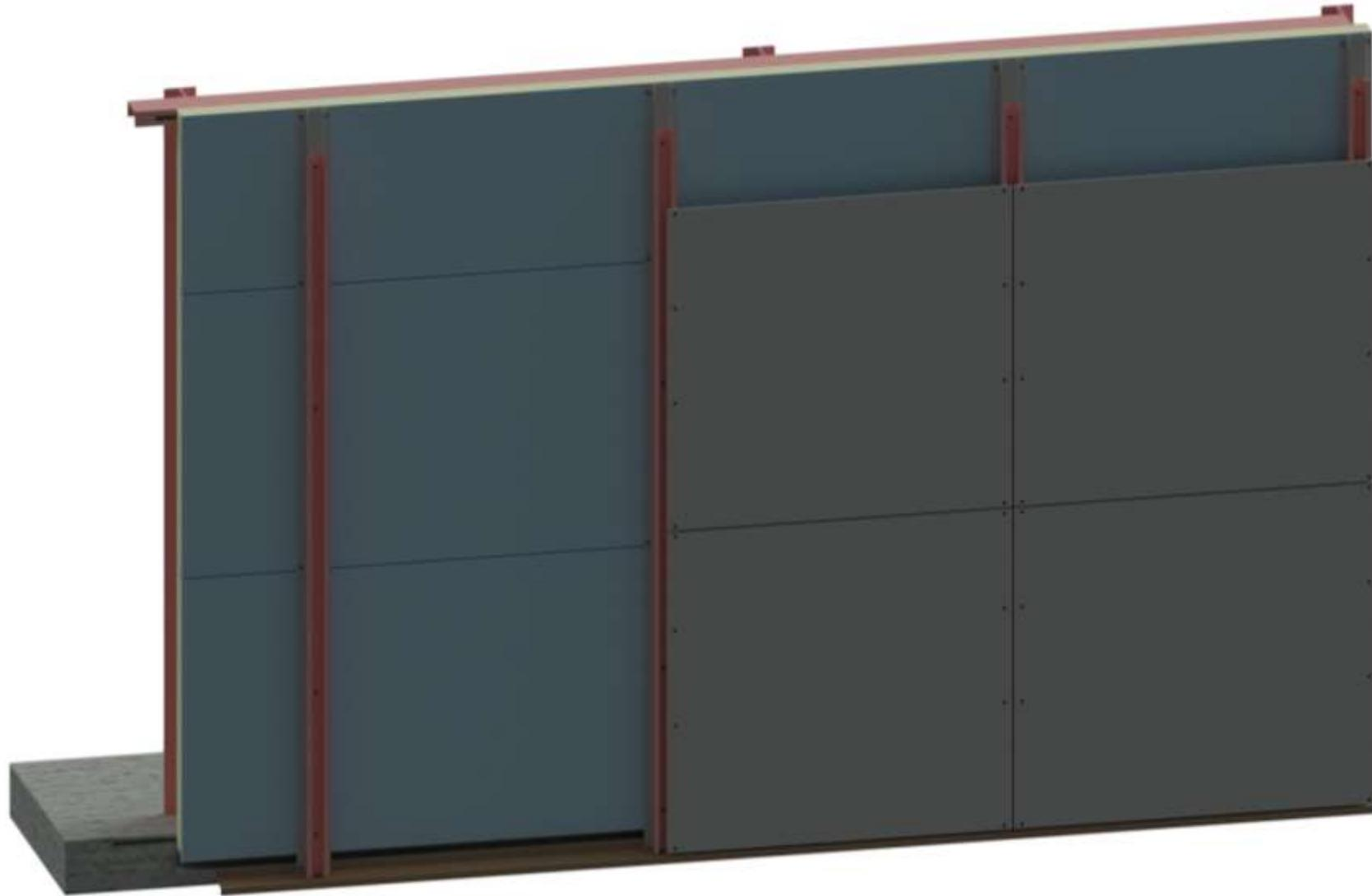
**Figure 4 : Exemple d'un parement extérieur de la typologie 5 avec pose en superposition sur les profilés fixés sur les panneaux sandwich isolants posés horizontalement.**
