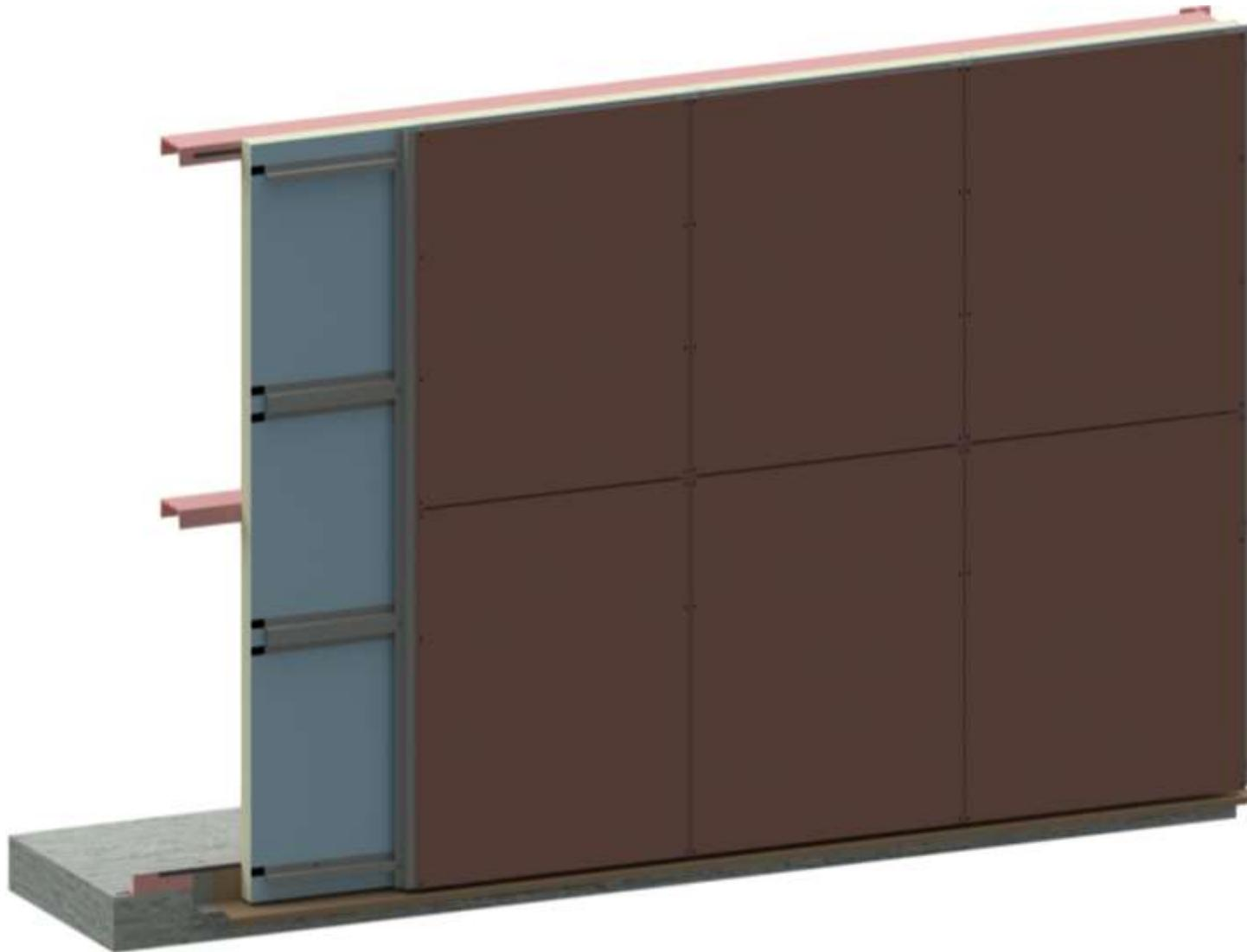
**Figure 14 : Exemple d'un parement extérieur de la typologie 5 en double réseau de profilés avec panneaux sandwich isolants posés verticalement**
