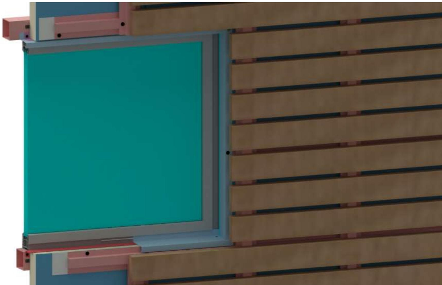
Figure 39 : Exemple de baie avec parement extérieur de la typologie 4 à « claire-voie » sur double réseau avec panneaux sandwich isolants posés verticalement – Vue 3D générale
