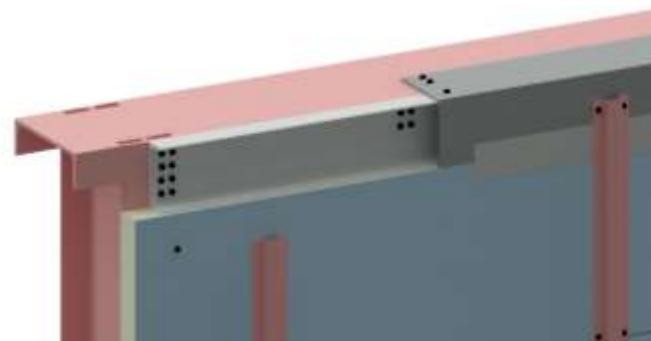
**Détail B** : Fixation de l'extrémité haute des profilés en forme d'oméga dans la cornière de fermeture du profil de reprise de charges en tête de façade par 2 vis. Et mis en œuvre d'une bande aluminium-butyl entre les panneaux et la cornière de fermeture
