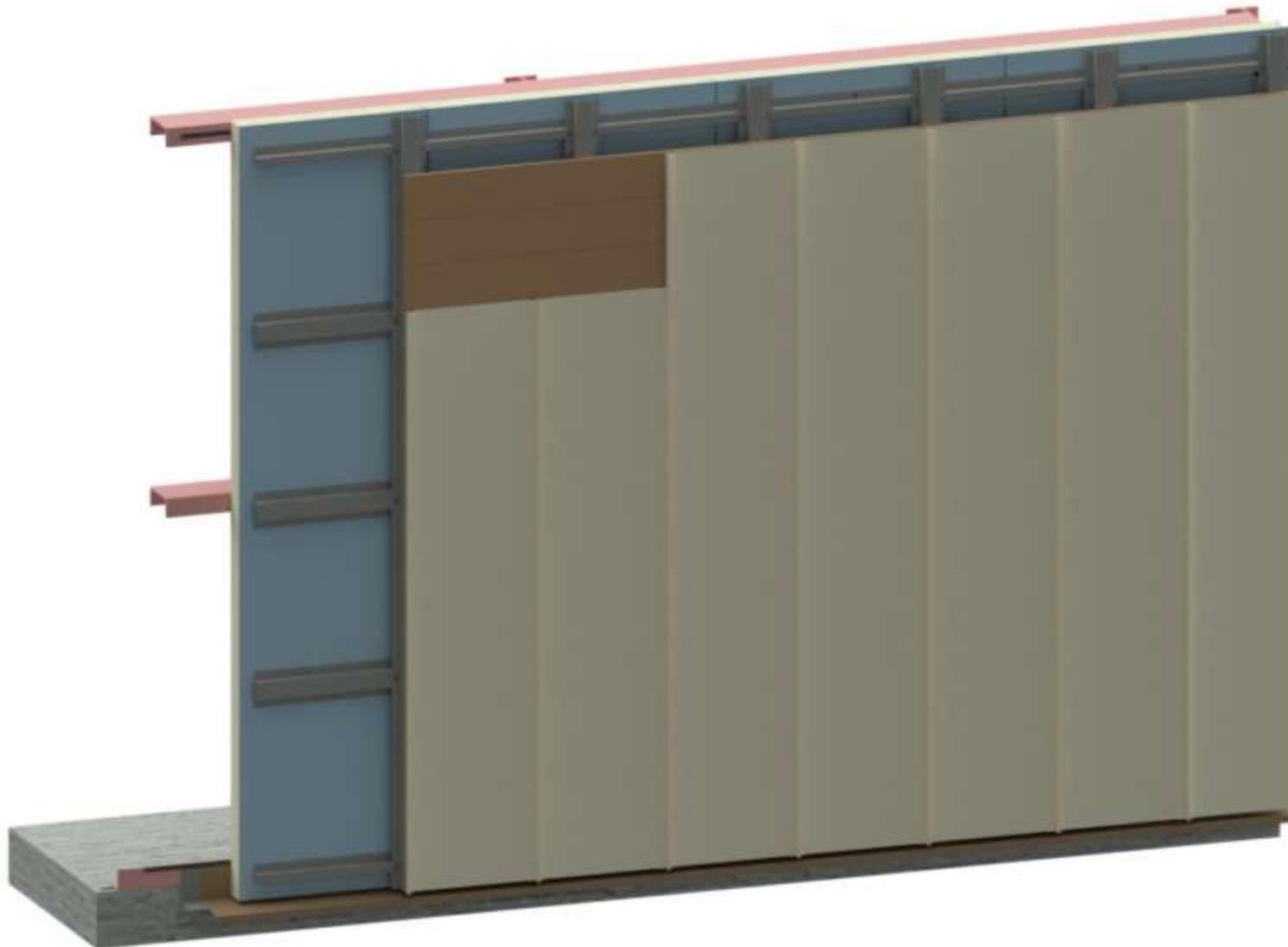
**Figure 17 : Exemple d'un parement extérieur de la typologie 7 sur voligeage disposé sur un double réseau de profilés avec panneaux sandwich isolants posés verticalement**
