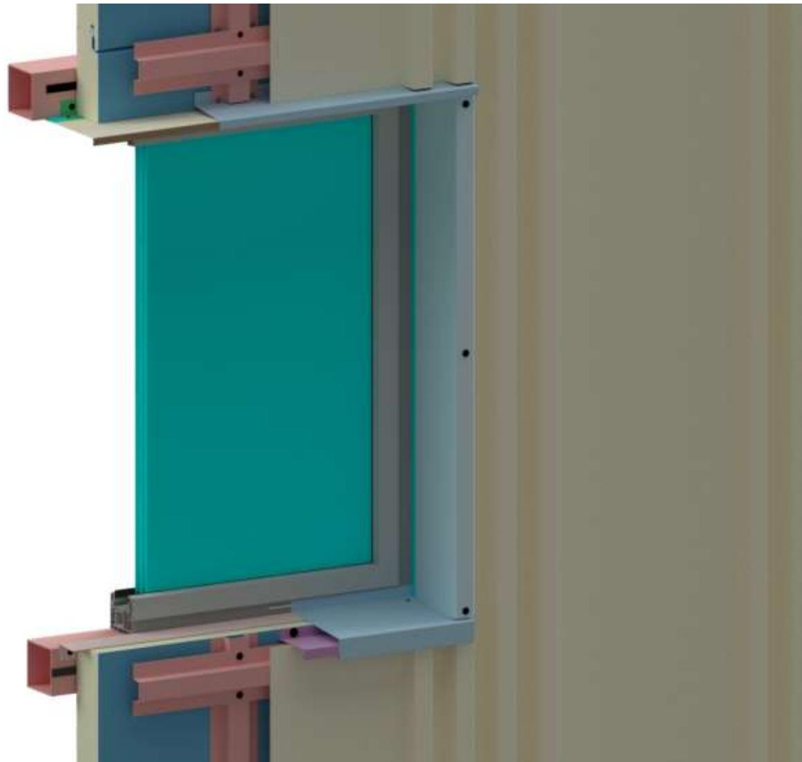
**Figure 37 : Exemple de baie avec parement extérieur de la typologie 1 sur double réseau avec panneaux sandwich isolants posés horizontalement – Vue 3D générale**
