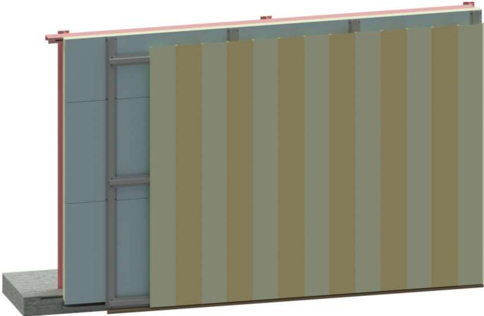
**Figure 7 : Exemple d'un parement extérieur de la typologie 2 avec pose sur double réseau de profilés avec panneaux sandwich isolants posés horizontalement.**
