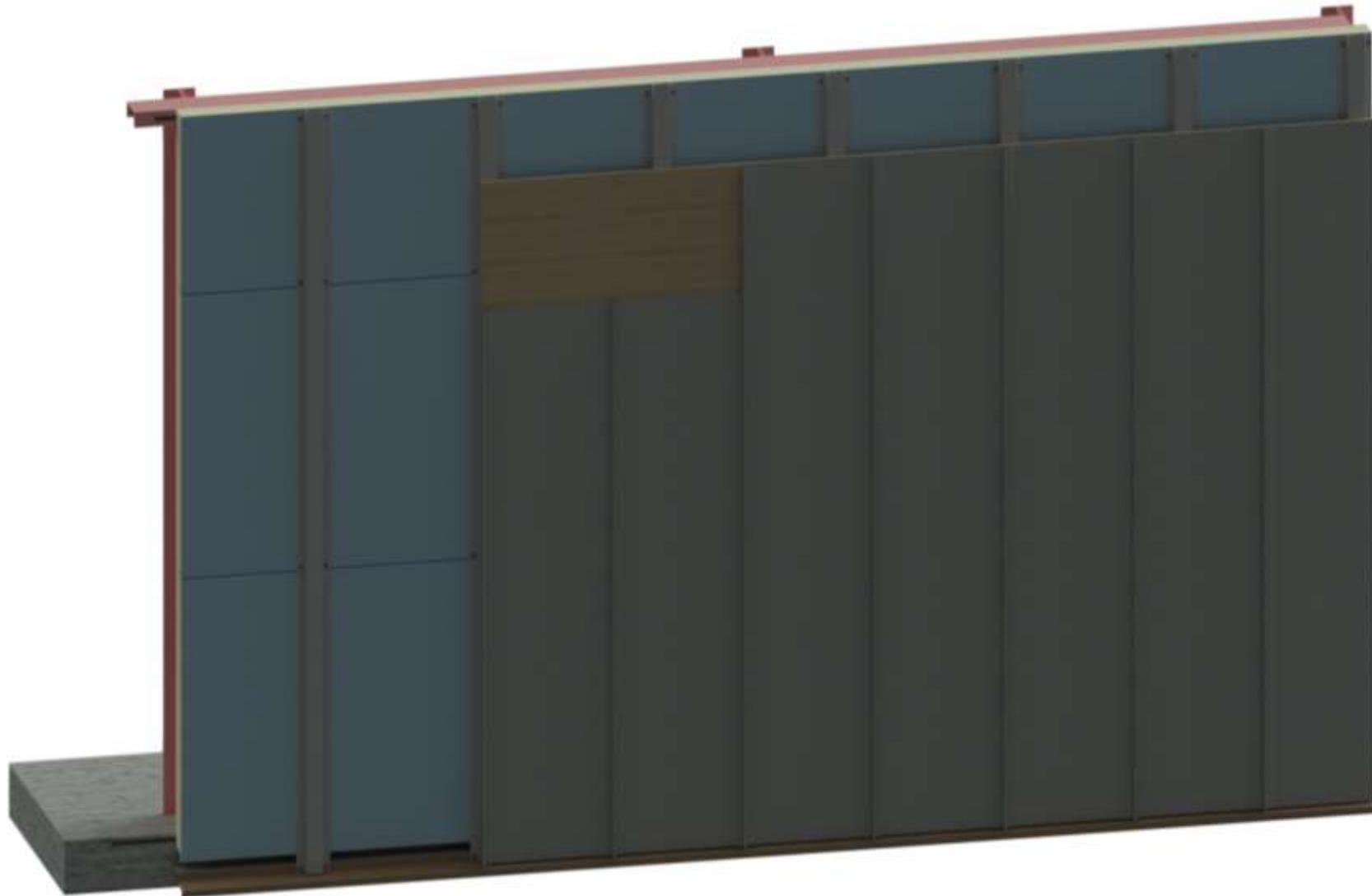
**Figure 6 : Exemple d'un parement extérieur de la typologie 7 avec pose sur voligeage disposé les profilés fixés sur les panneaux sandwich isolants posés horizontalement.**
