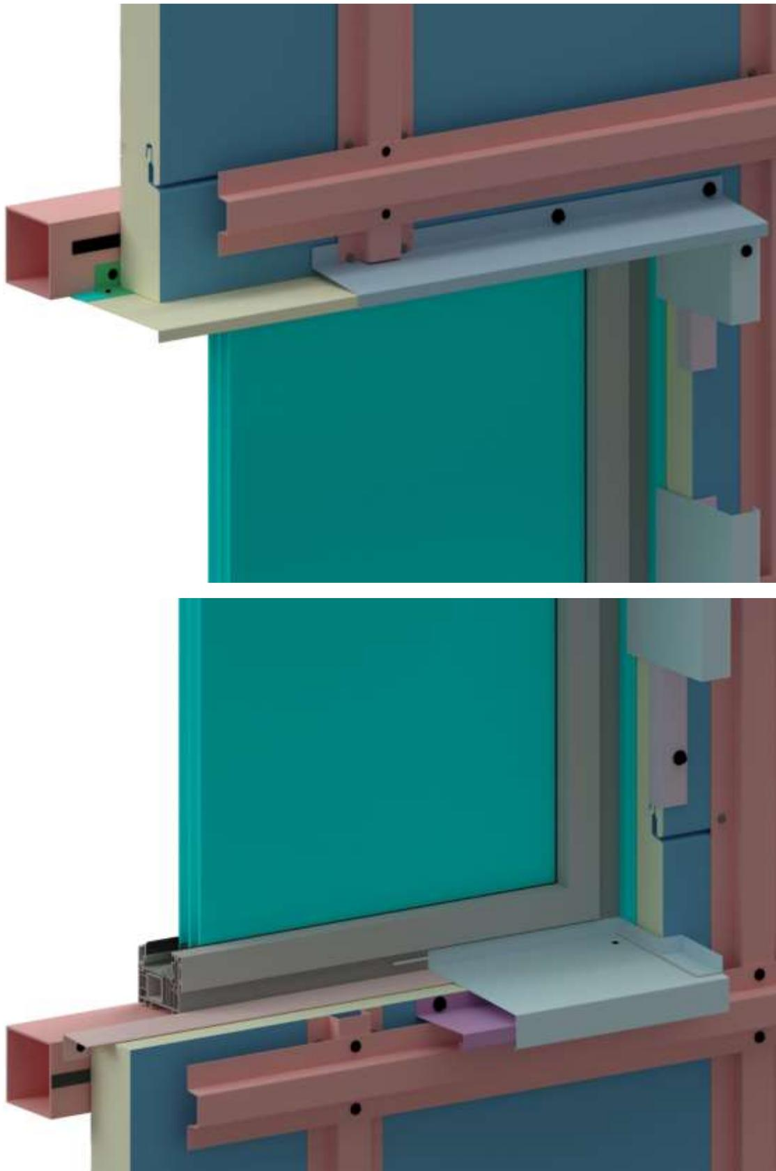
**Figure 37 bis : Exemple de baie avec parement extérieur de la typologie 1 sur double réseau avec panneaux sandwich isolants posés horizontalement – Vues 3D détails**
