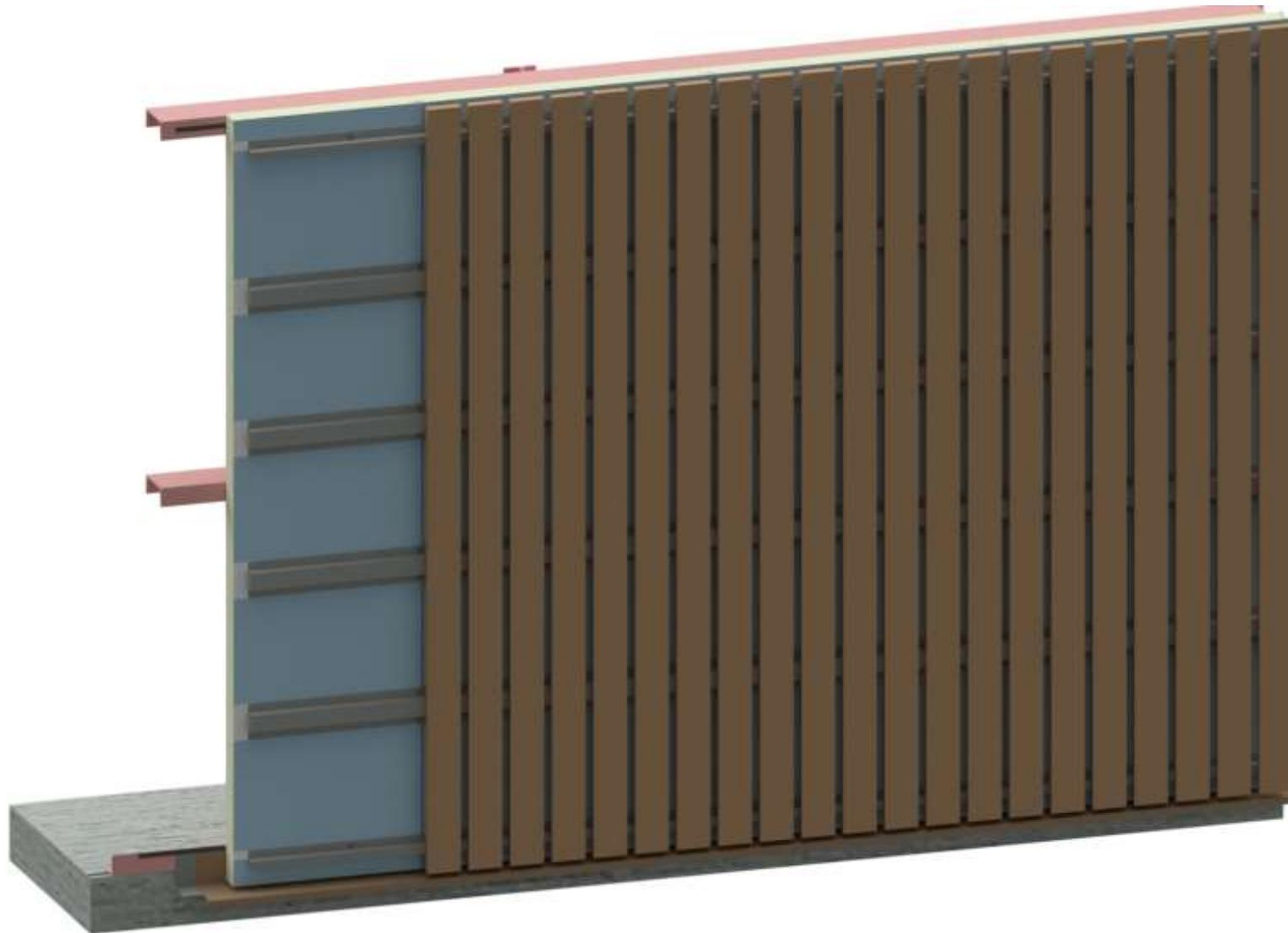
**Figure 13 : Exemple d'un parement extérieur de la typologie 4 en pose directe sur les profilés fixés sur les panneaux sandwich isolants posés verticalement**
