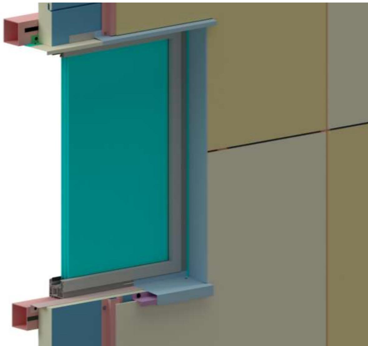
**Figure 36 : Exemple de baie avec parement extérieur de la typologie 5 sur simple réseau avec panneaux sandwich isolants posés horizontalement – Vue 3D générale**
