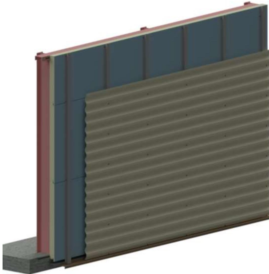
**Figure 2 : Exemple d'un parement extérieur de la typologie 1 en pose directe sur les profilés fixés sur les panneaux sandwich isolants posés horizontalement**
