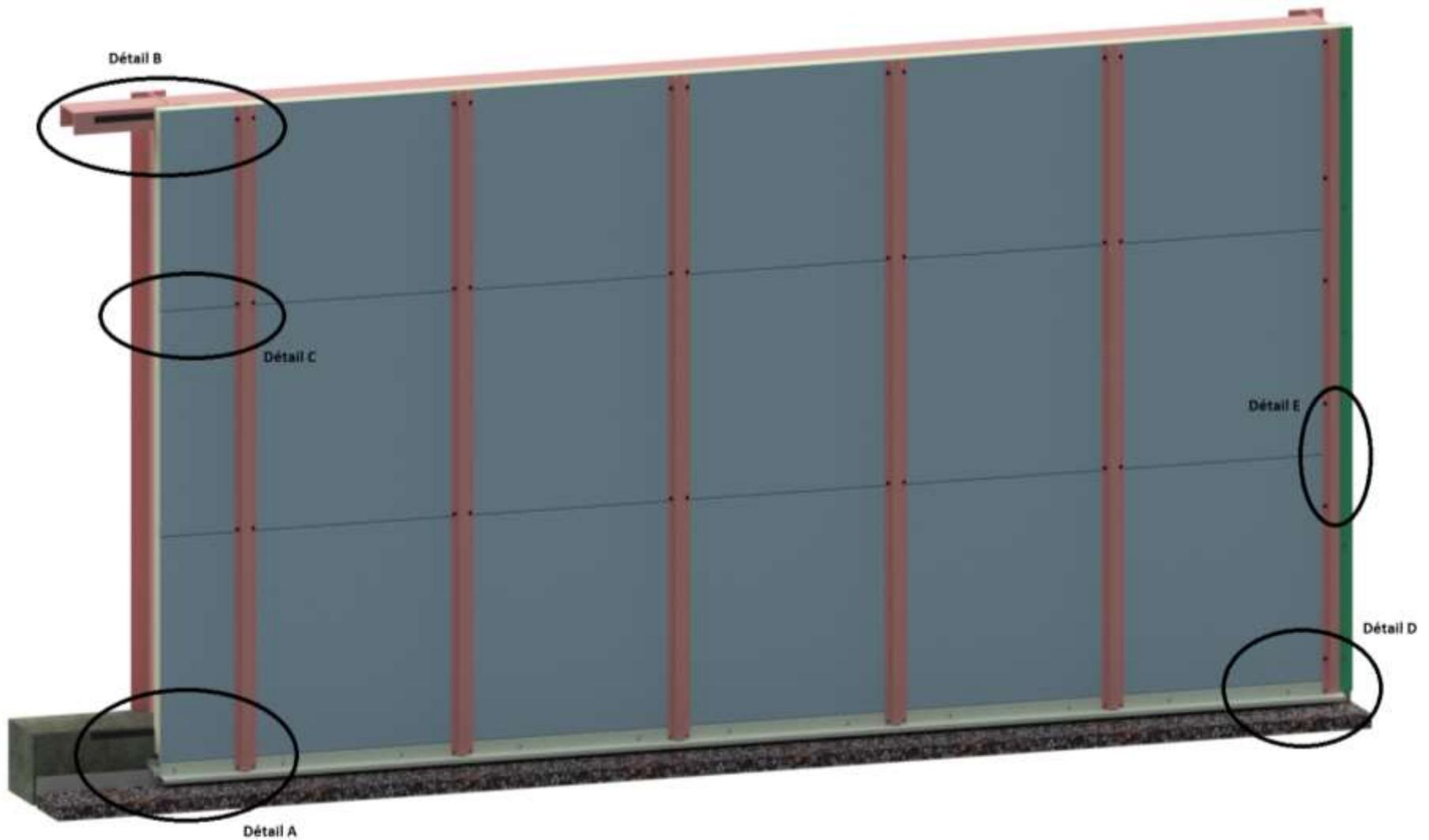
Figure 1 : Schéma de principe avec profilés fixés sur les panneaux sandwich isolants posés horizontalement - Parements extérieurs des typologies 1 à 7
