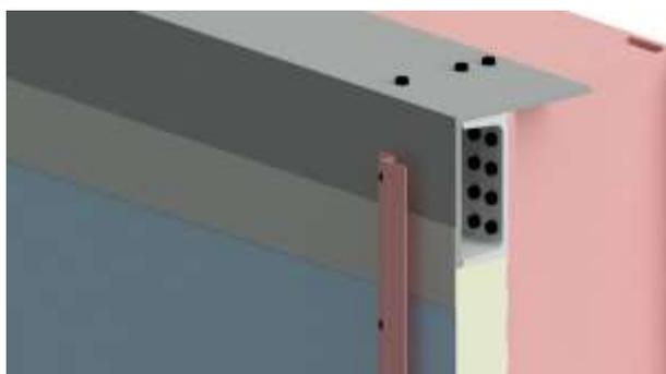
**Détail E** : Fixation l'extrémité haute des profilés en forme de zed dans la cornière de fermeture du profil de reprise de charges en tête de façade par 1 vis. Et mis en œuvre d'une bande aluminium-butyl entre les panneaux et la cornière de fermeture.
