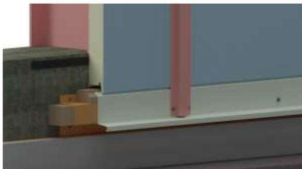
**Détail A** : Fixation de l'extrémité basse des profilés en forme d'oméga sur le profil support en pied de façade par 2 vis.
