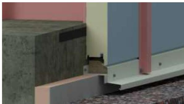
**Détail A** : Fixation de l'extrémité basse des profilés en forme d'oméga sur le profil support par 2 vis.
