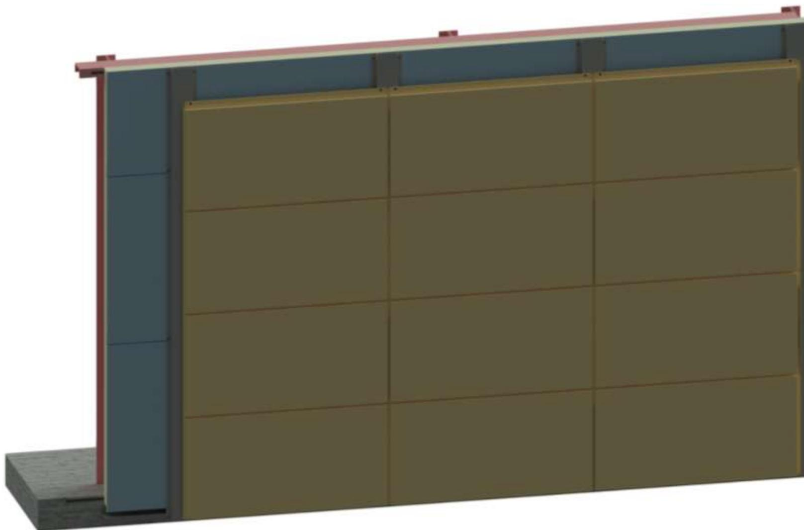
**Figure 3 : Exemple d'un parement extérieur de la typologie 3 en pose directe sur les profilés fixés sur les panneaux sandwich isolants posés horizontalement.**
