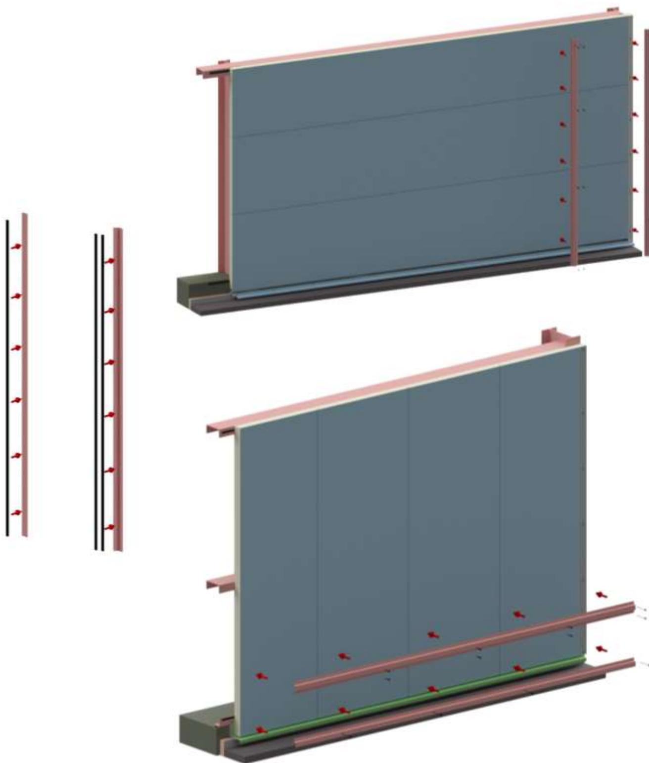
Mise en place des joints mousse sur les profilés avant fixation sur les panneaux
