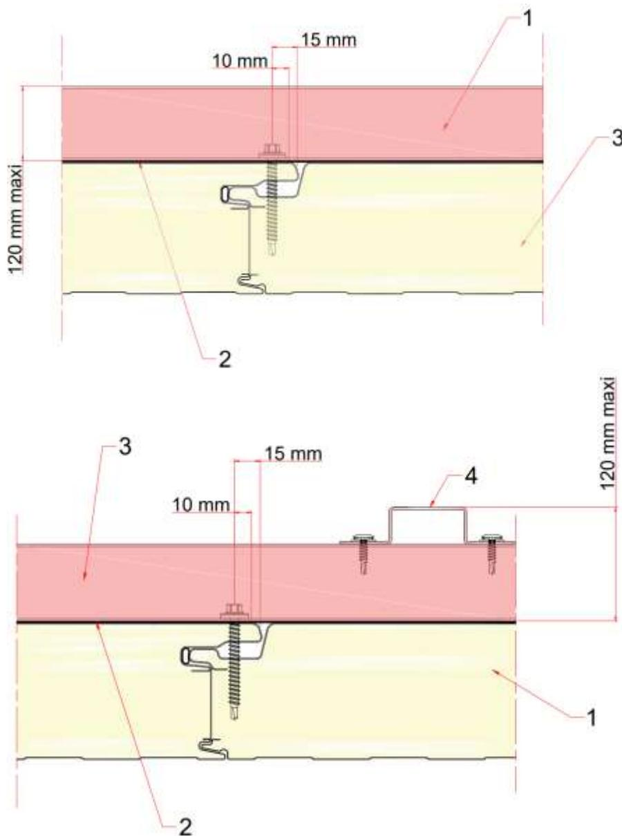
**1 : Panneau sandwich isolant d'épaisseur minimale 80 mm**
