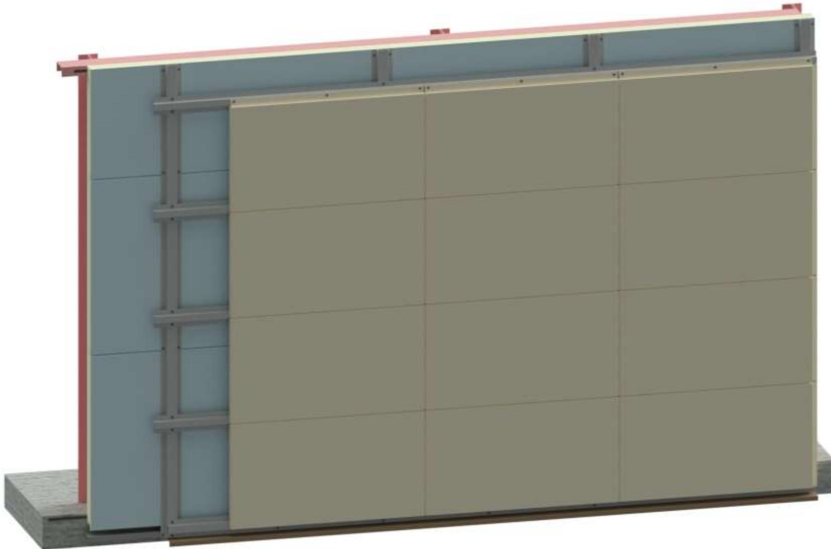
**Figure 9 : Exemple d'un parement extérieur de la typologie 5 sur double réseau de profilés avec panneaux sandwich isolants posés horizontalement.**
