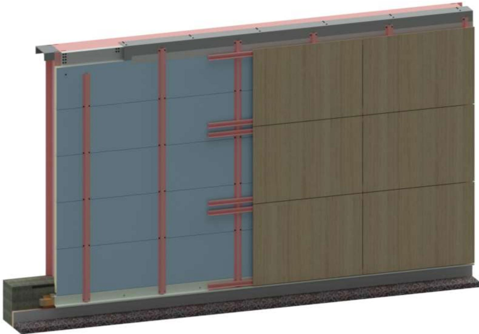
**Figure 19 : Exemple d'un parement extérieur de la typologie 8 sur un double réseau de profilés avec panneaux sandwich isolants posés horizontalement**
