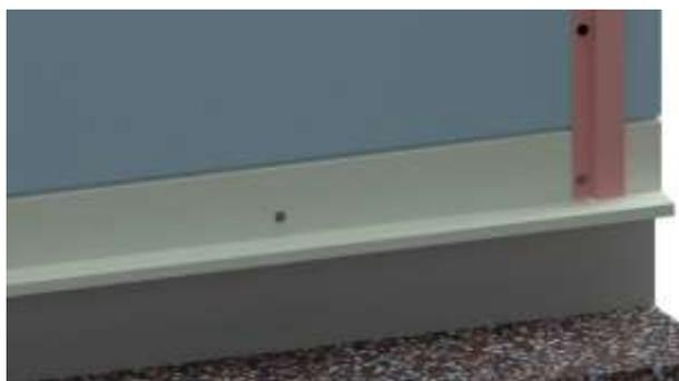
**Détail D** : Fixation de l'extrémité basse des profilés en forme de Zed sur le profil support par 1 vis.
