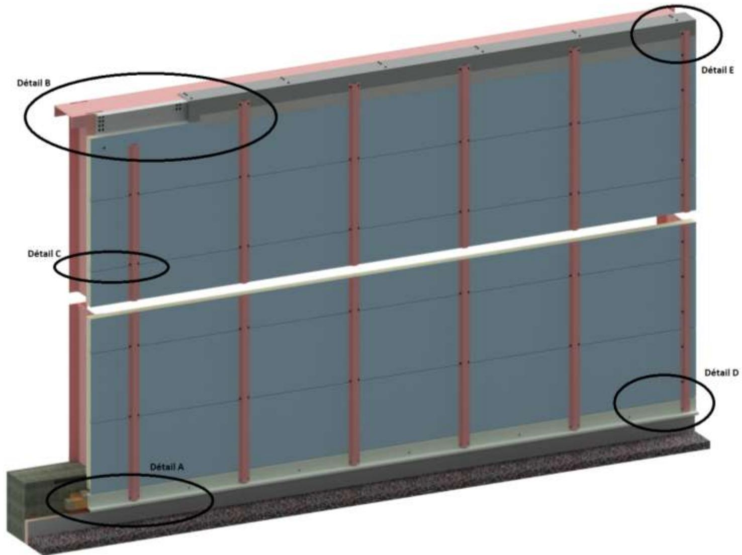
Figure 18 : Schéma de principe avec profilés fixés sur les panneaux sandwich isolants posés horizontalement – Parements extérieurs de la typologie 8
