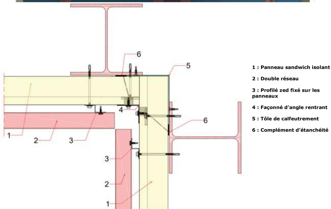
**Figure 34 bis : Schéma de principe d'un angle rentrant avec double réseau et panneaux sandwich isolants posés horizontalement**
