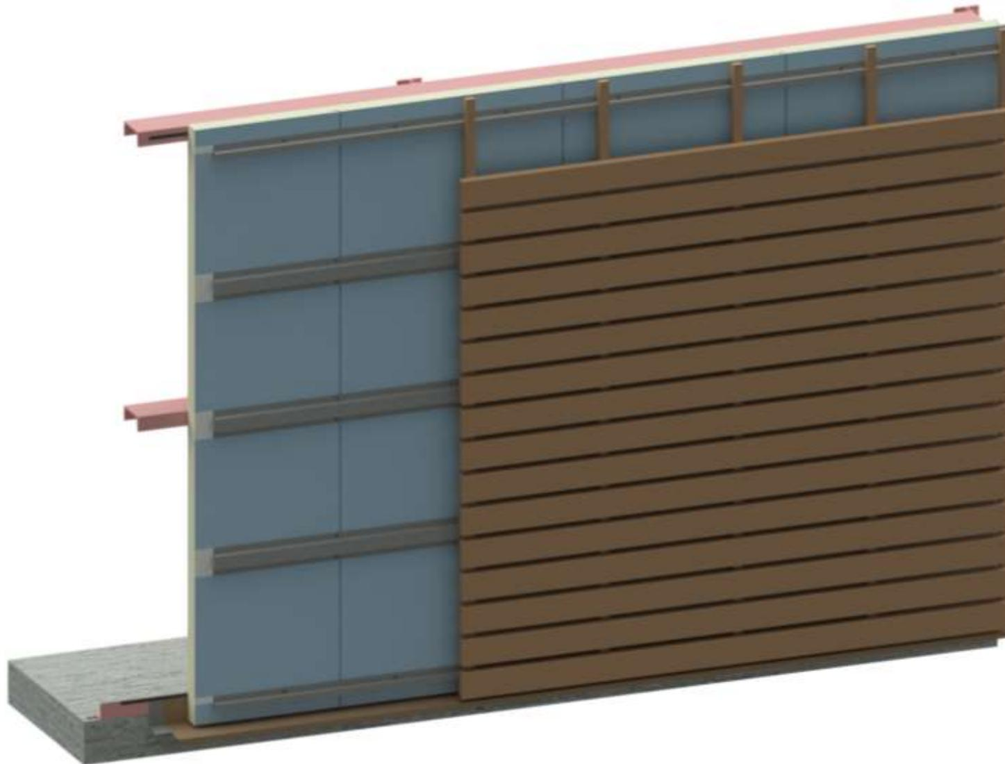
**Figure 16 : Exemple d'un parement extérieur de la typologie 4 avec chevrons en tant que double réseau avec panneaux sandwich isolants posés verticalement**
