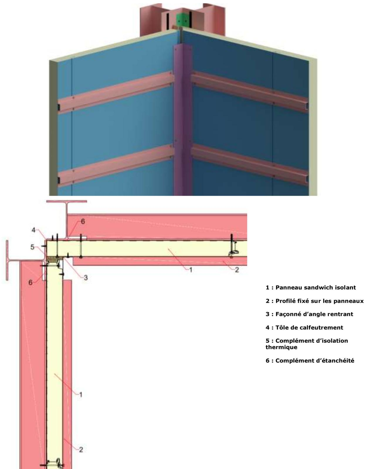
**Figure 35 : Schéma de principe d'un angle rentrant avec simple réseau et panneaux sandwich isolants posés verticalement**
