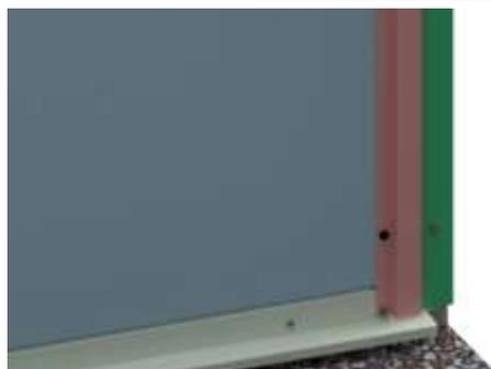
**Détail D** : Fixation de l'extrémité basse des profilés en forme de Zed sur le profil support par 1 vis.
