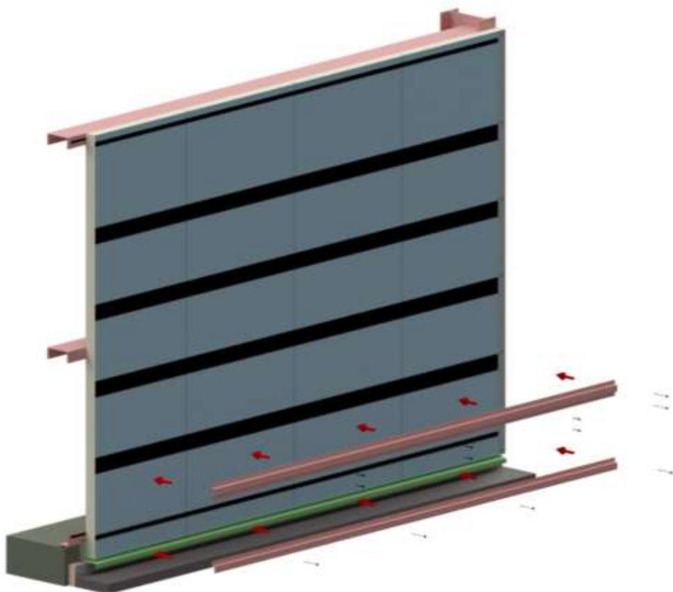
Mise en place des Bandes EPDM et/ou aluminium-butyl avant fixations des profilés sur les panneaux
