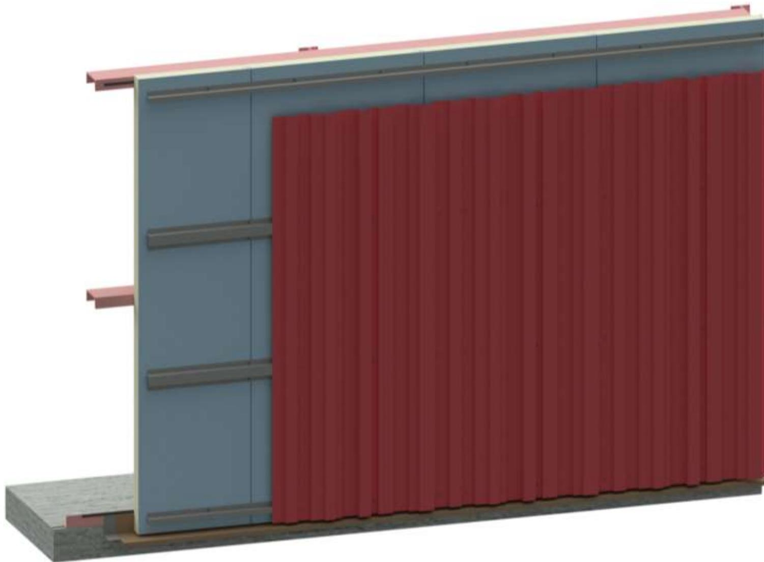
**Figure 11 : Exemple d'un parement extérieur de la typologie 1 en pose directe sur les profilés fixés sur les panneaux sandwich isolants posés verticalement**
