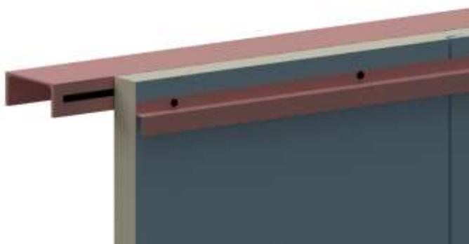
**Détail B** : Fixation des profilés en forme zed à travers le panneau sandwich isolant dans la lisse hausse de charpente.
