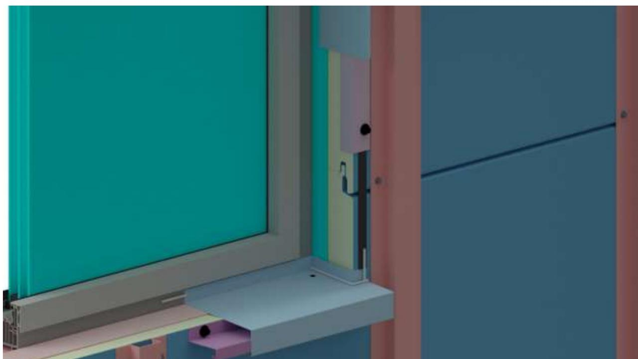
**Figure 36 bis : Exemple de baie avec parement extérieur de la typologie 5 sur simple réseau avec panneaux sandwich isolants posés horizontalement – Vues 3D détails**
