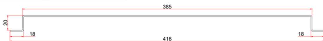
Figure 52 bis – Exemple d'un joint de dilatation dont le déplacement maximal est de 150 mm avec panneau sandwich isolant Louvre en pose horizontale
