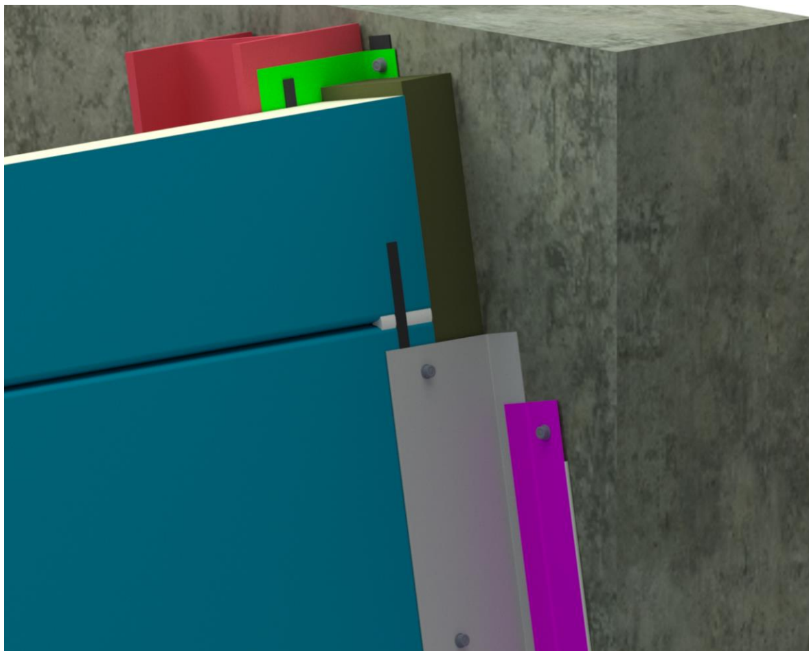
Figure 12 ter – Dispositions complémentaires sur façade inclinée à fruit positif maximal 10° (inclinaison vers l'intérieur) – Rive contre mur
