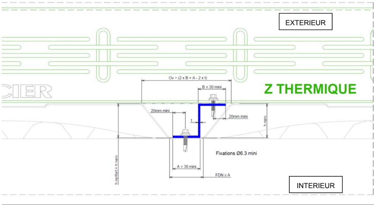
Figure 3b – Cotes d'un renfort Z et bardage à nervures rentrantes
