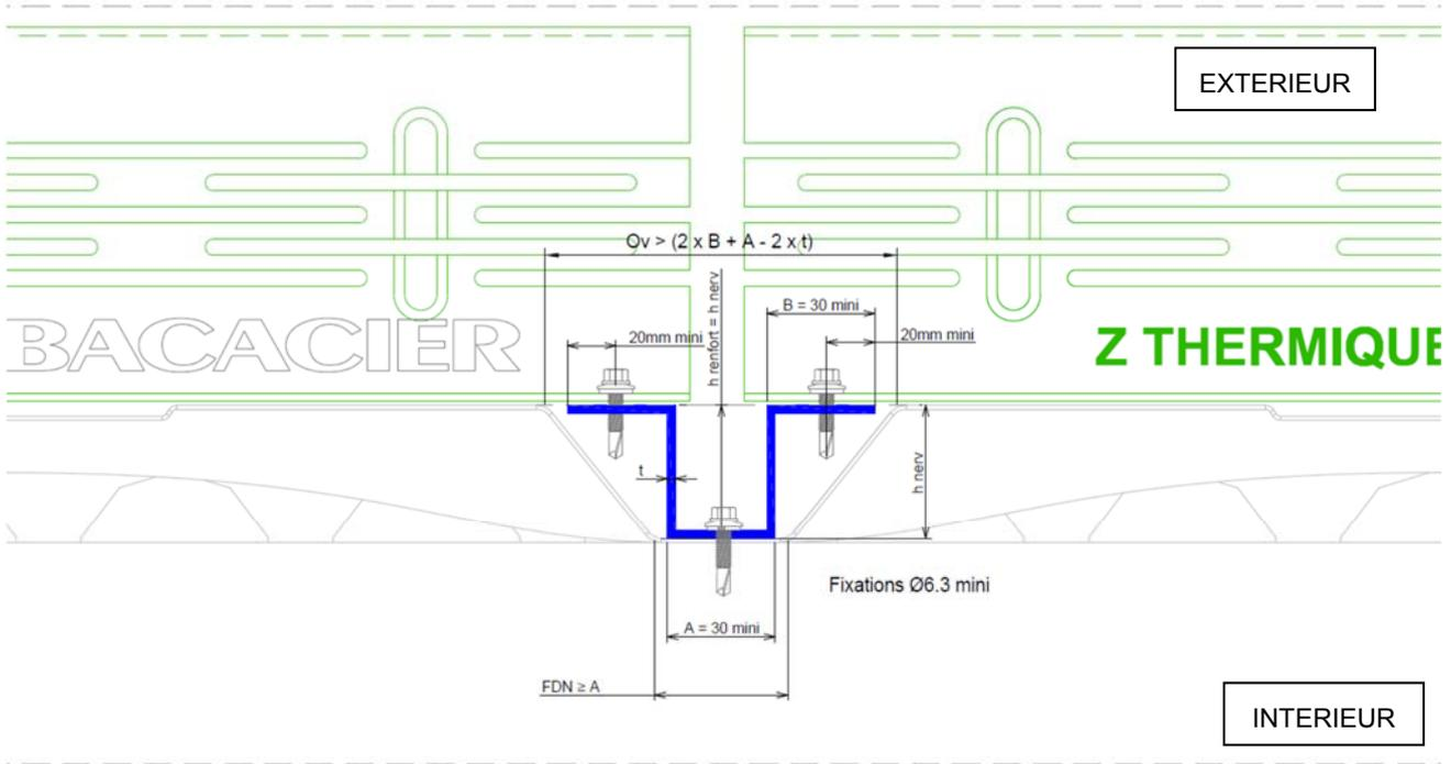
Figure 3c – Cotes d'un renfort Omega inversé et bardage à nervures rentrantes
