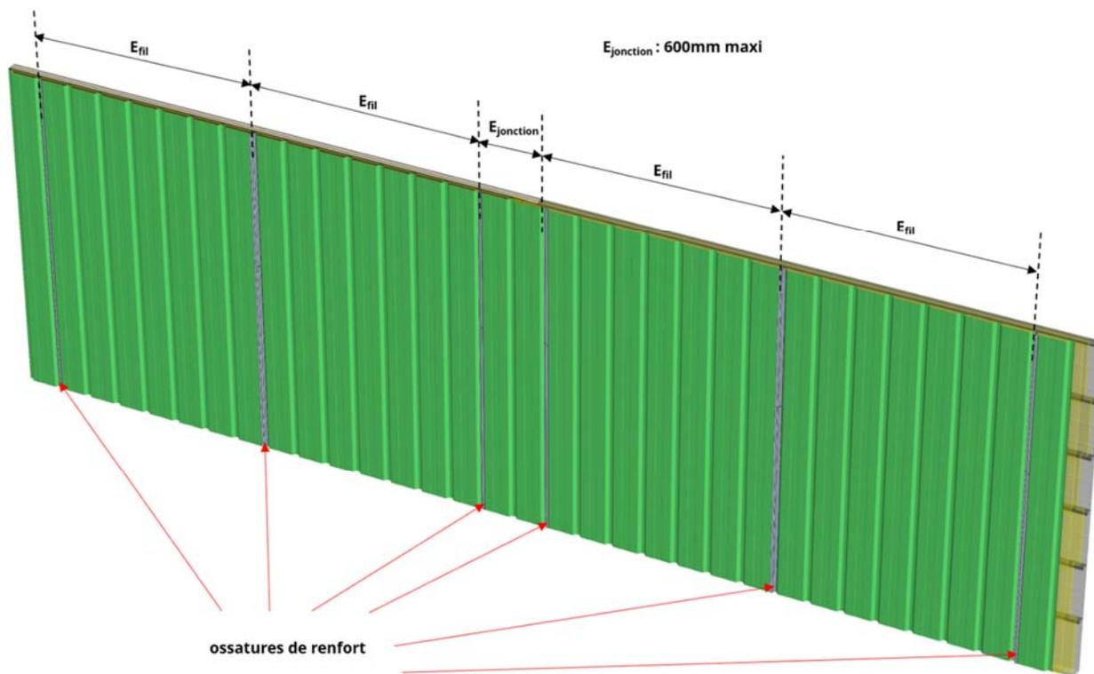
I2 - Mise en place des renforts en fond de nervure Z (30x25x30mm) 1 fixation à chaque croisement ossature de renfort / lèvre de plateau
