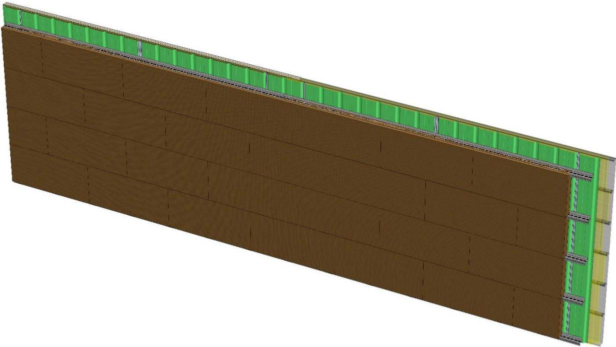
*I4 - Mise place de l'isolant ROCKBARDAGE RENO épaisseur 110mm – Pose de l'isolant en quinconce*
