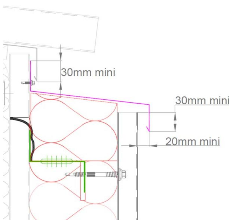
Figure 11a- Haut de bardage - Egout, cas d'une solution sans ossature secondaire
