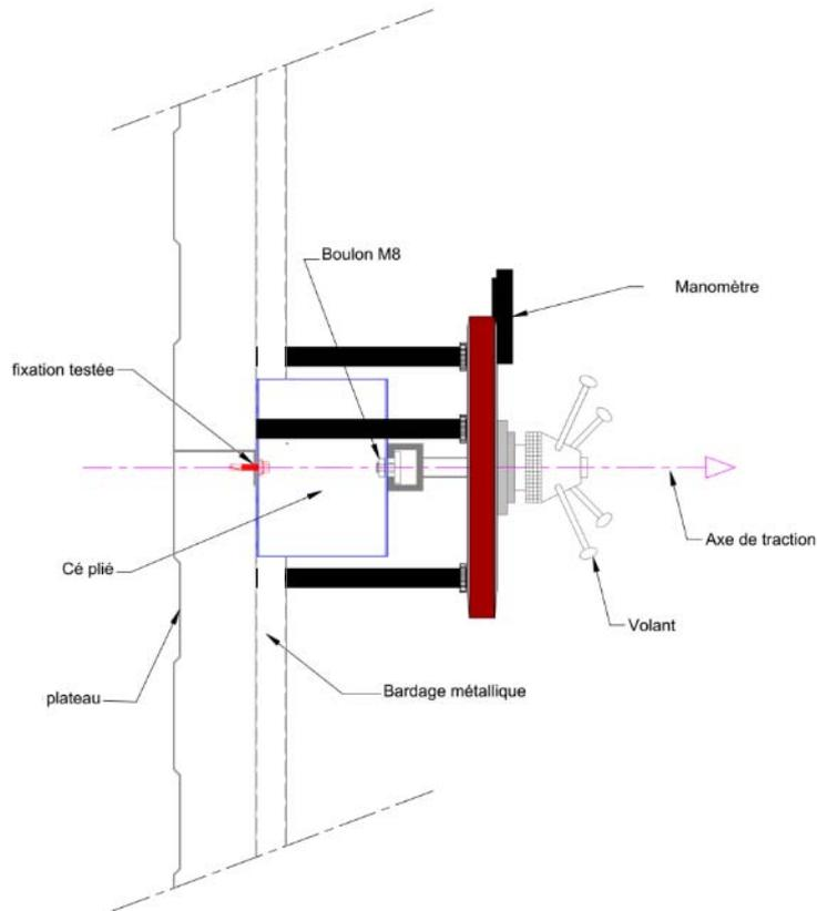
**Exemple d'appareillage d'essai**
