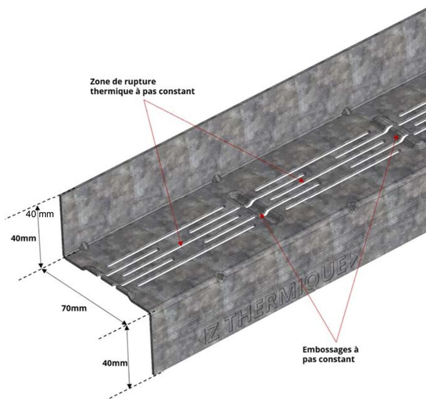
Figure 2 - Géométrie du Z THERMIQUE® 70 (épaisseur : 1,5 mm)
