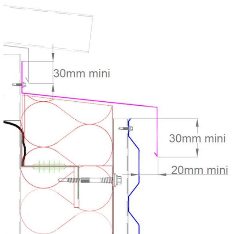
Figure 11b- Haut de bardage - Egout, cas d'une solution avec ossature secondaire
