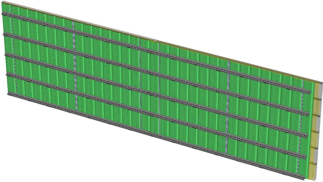
*I3 - Mise en place des Z Thermique - Espacement 600mm maxi – 1 fixation à chaque croisement Z Thermique / Ossature de renfort*
