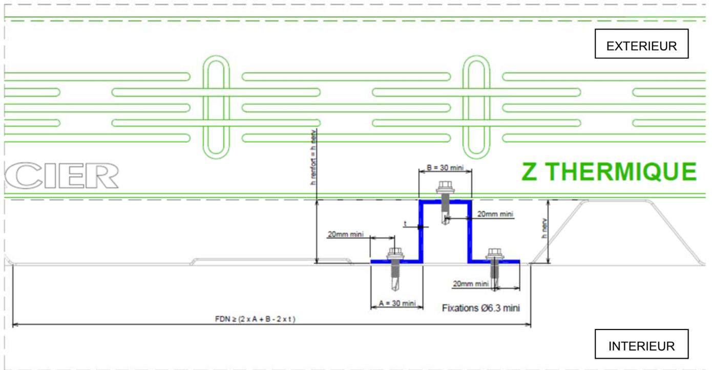
Figure 3d – Cotes d'un renfort Omega et bardage à nervures sortantes
