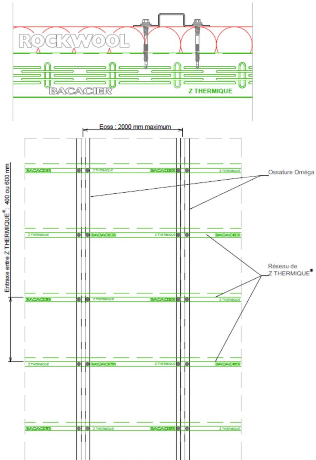
Figure 4a - Schéma de principe de fixations des ossatures secondaires - Deux fixations par intersection Omega / Z THERMIQUE®
