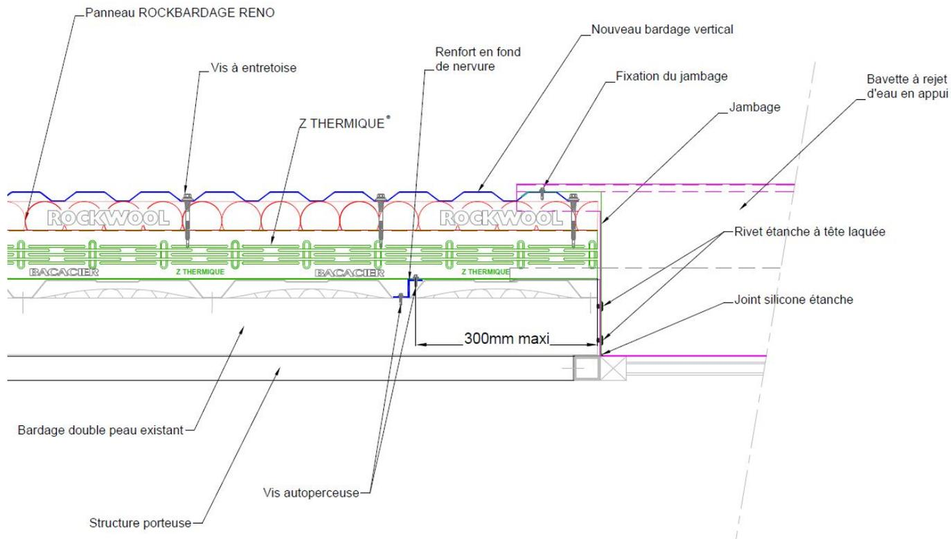
Figure 15a - Exemple de traitement de baies, coupe horizontale, cas d'une solution sans ossature secondaire
