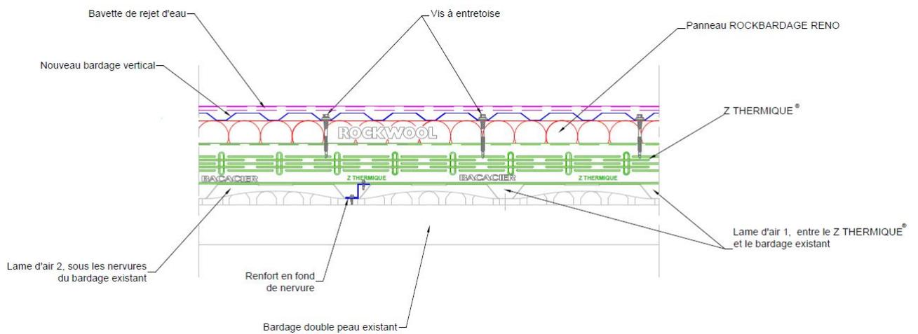
**Figure 8b – Bas de bardage, cas d'une solution sans ossature secondaire – Position des lames d'air internes**
