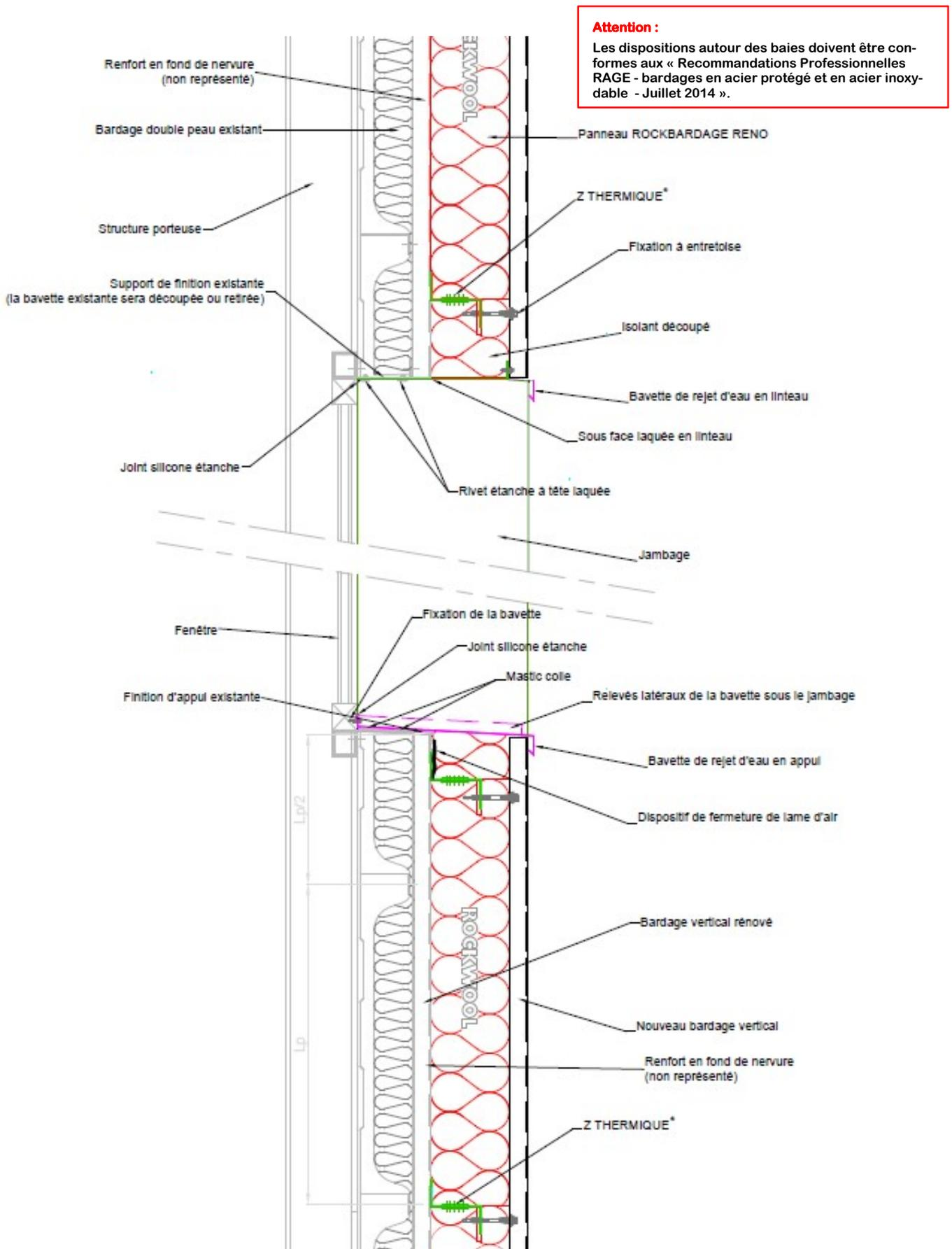
Figure 14a – Exemple de traitement de baies, coupe verticale, cas d'une solution sans ossature secondaire
