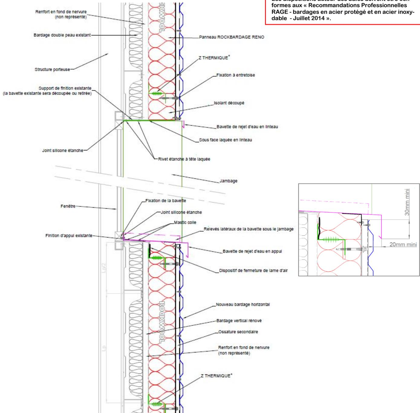
Figure 14b – Exemple de traitement de baies, coupe verticale, cas d'une solution avec ossature secondaire
