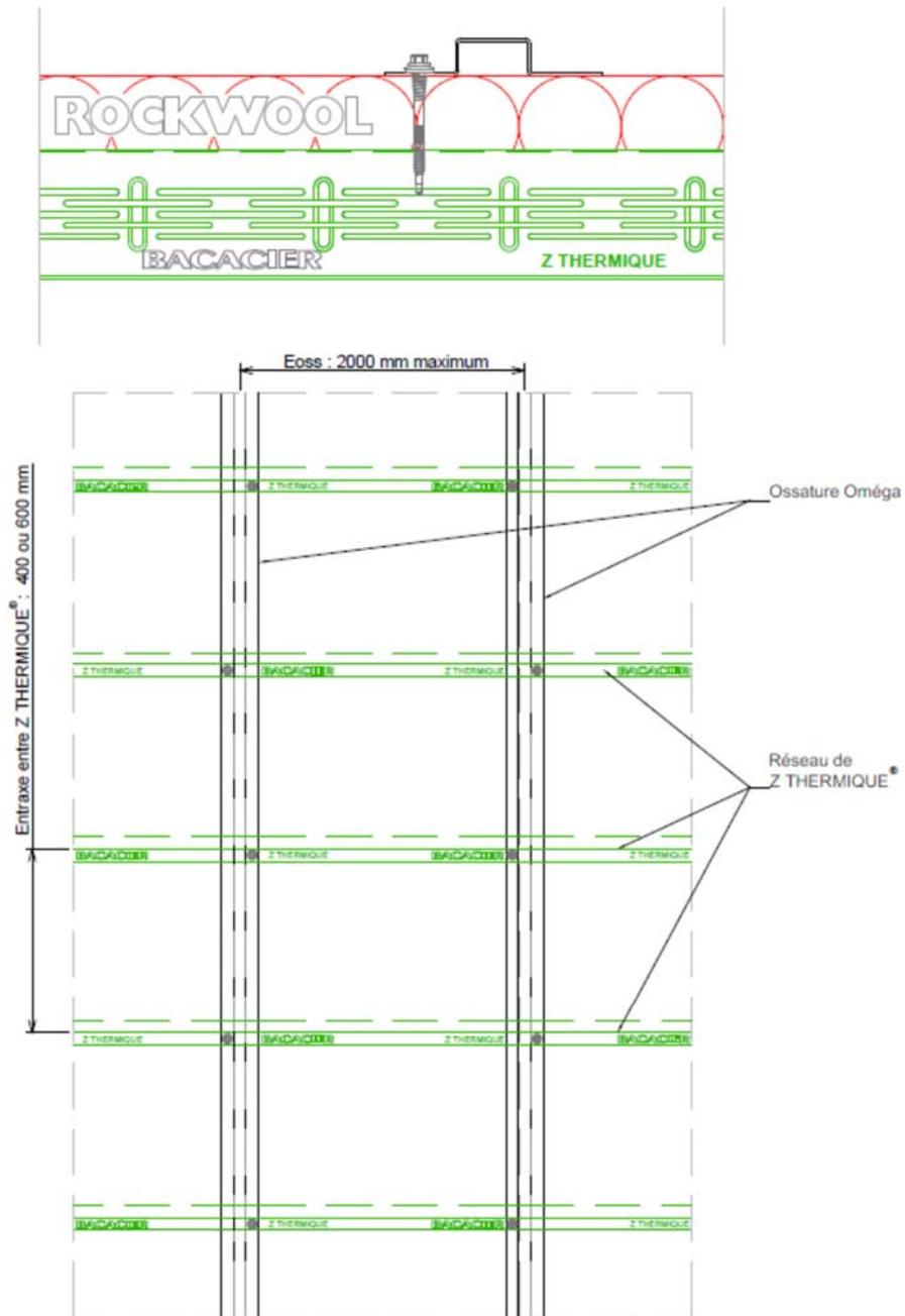
Figure 4b - Schéma de principe de fixations des ossatures secondaires - Une fixation par intersection Oméga / Z THERMIQUE®
