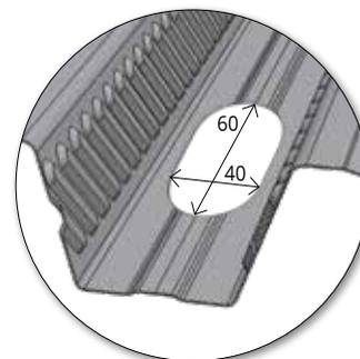
Le plancher collaborant PCB 60 est disponible en version pré percée (trous oblongs de longueur 60 mm et de largeur 40 mm). Le plan de perçage est à fournir.
