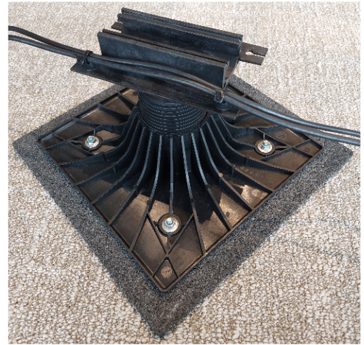
Figure 24 : Fixation câble électrique sur le plot standard à l'aide de collier Rislant et plot SOPRASOLAR FIX EVO -6- à l'aide d'un accessoire qui se fixe dans l'encoche de l'ailette
