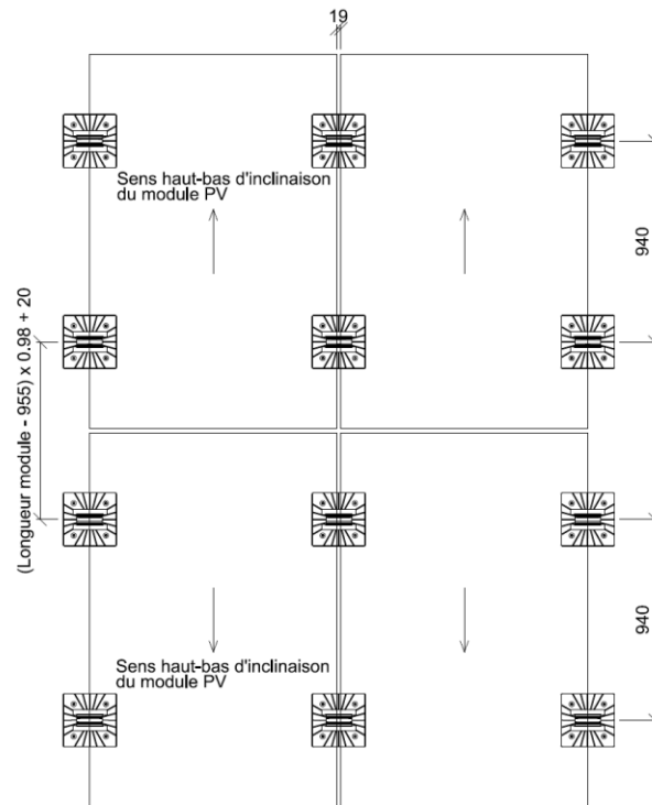
Figure 34 : Implantation des plots SOPRASOLAR FIX EVO avec modules photovoltaïques en inclinaison double shed – rehausse polymère 210 et réhausse aluminium 210
