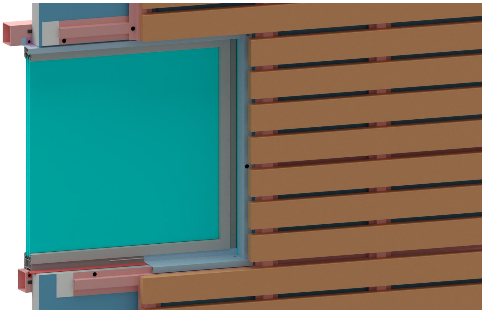
Figure 38 : Exemple de baie avec parement extérieur de la typologie 3 à « claire-voie » sur double réseau avec panneaux sandwich isolants posés verticalement – Vue 3D générale
