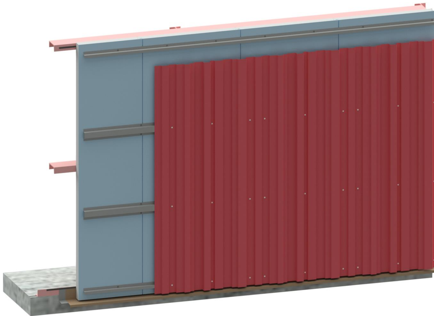
Figure 10 : Exemple d'un parement extérieur de la typologie 1 en pose directe sur les profilés fixés sur les panneaux sandwich isolants posés verticalement
