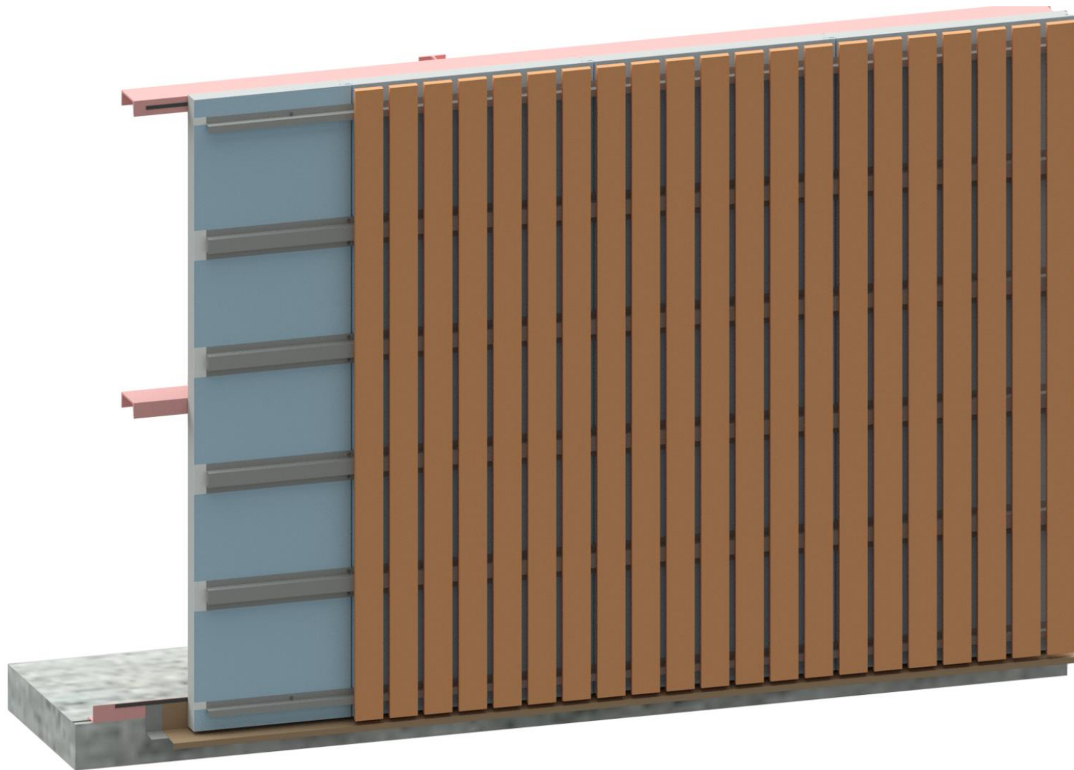
Figure 12 : Exemple d'un parement extérieur de la typologie 3 en pose directe sur les profilés fixés sur les panneaux sandwich isolants posés verticalement
