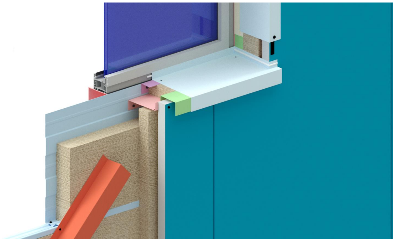
Figure 10 – BENCHMARK Korporate 1 avec pose verticale des panneaux sandwich isolants – Exemple de baie (vues 3D)
