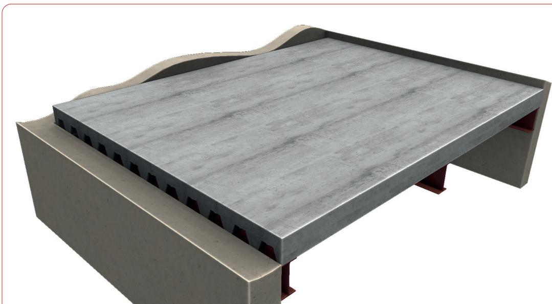
Le dimensionnement des planchers est effectué sur la base d'un béton ayant atteint ses caractéristiques minimales à 28 jours.
