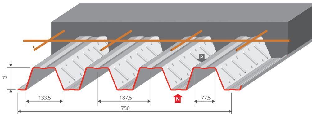
Détail géométrique de la tôle
