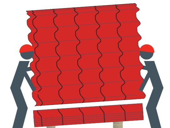
Il est conseillé de manipuler les panneaux à 2 personnes. Le panneau est porté verticalement, afin qu'il ne plie pas. Vous pouvez placer 2 traverses dans le prolongement du pan de toiture jusqu'au sol pour soutenir les panneaux lorsqu'ils sont tirés sur le toit. Marchez toujours dans le creux de l'onde.
