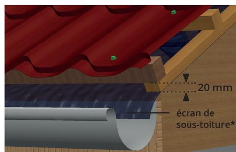
Pour assurer une bonne ventilation de votre toiture une lame d'air de 20mm minimum doit être créée.
